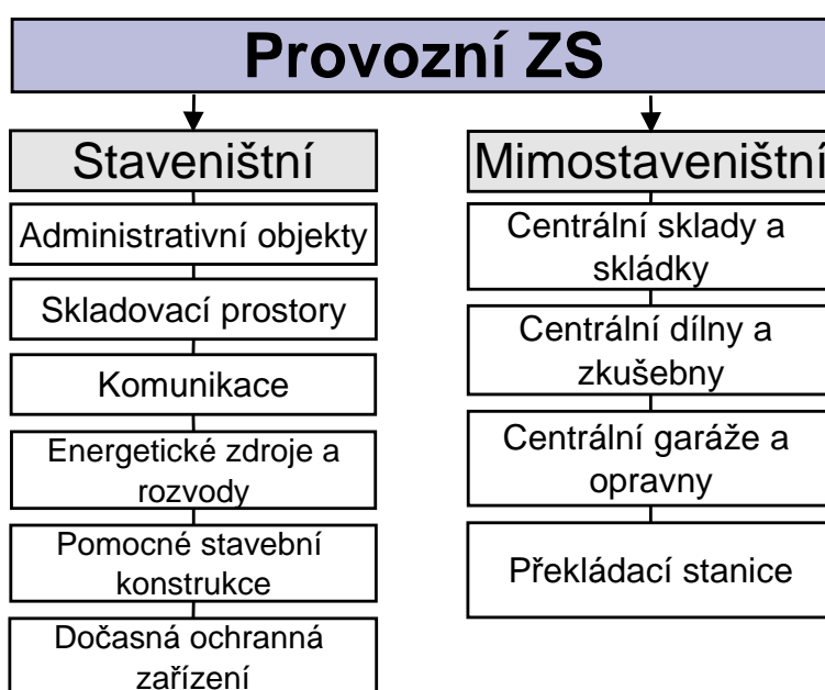
Obrázek 1 - Členění provozního zařízení staveniště
