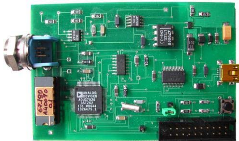
Obr. 8.1: Měřící přípravek použitý k propojení elektrochemického senzoru s integrovaným potenciostatem a počítačového softwaru, který je určen pro voltametrická měření.
