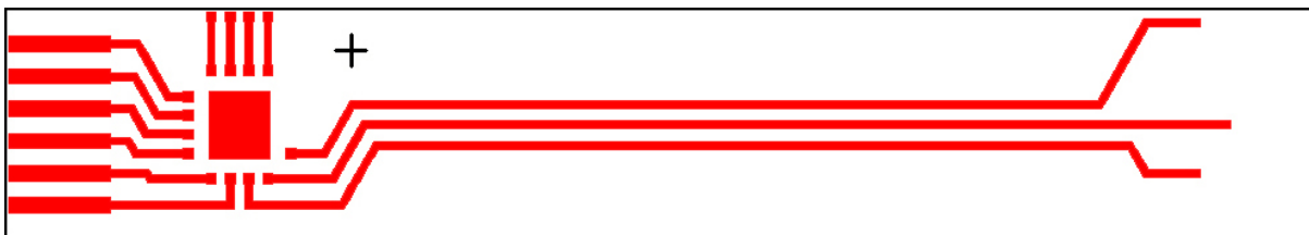
Obr. 7.2: Maska: substrát ( substrate_layer ) s hladinou vodivých cest ( conductive_layer ) a hladinou pro čip IMAM ( ASIC_layer ).
