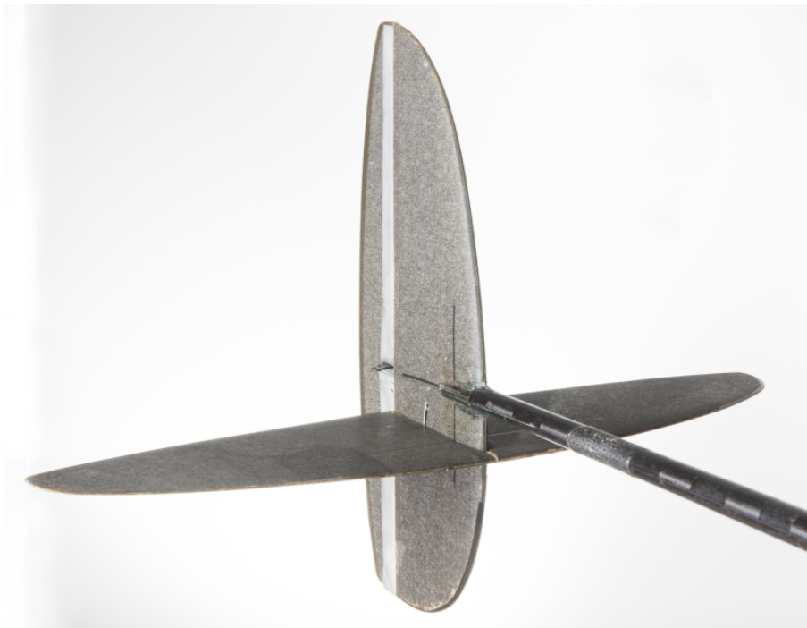
Obrázek 2.3: Ocasní plochy modelu FW5 Flow.
