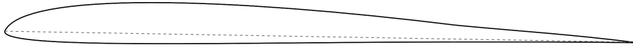
Obrázek 3.3: Konfigurace profilu křídla v letové fázi kluz, flaperon vychýlen o 0^\circ (profil AG455ct [5]).
