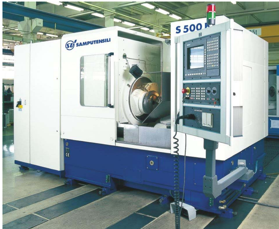
Obr. 3.17 Obráběcí stroj na výrobu kuželových kol [6]
