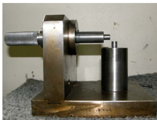
Obr. 3.13 Kontrolní probíhací přístroj
