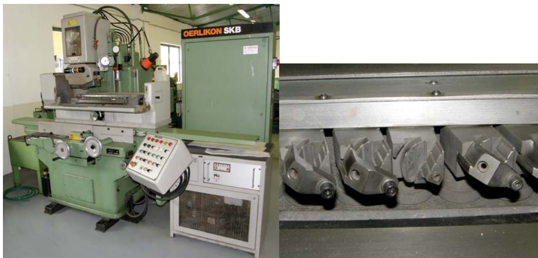
Obr. 3.23 Speciální bruska na broušení nožů
