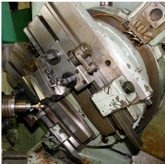
Obr. 3.11 Otočná nožová hlava s upnutými noži
