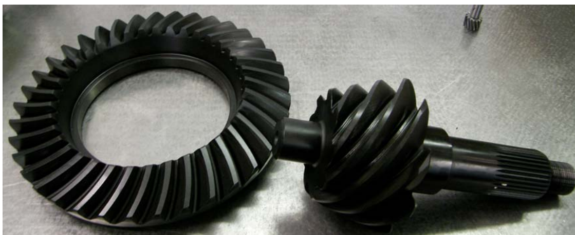
Obr. 3.20 Kuželové soukolí s paloidním ozubením
