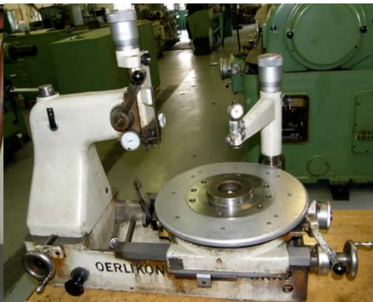
Obr. 3.26 Přístroj na kontrolu břitů nožů nožové hlavy
