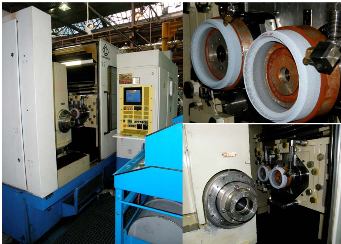
Obr. 3.30 Bruska pro výrobu eloidního ozubení kuželových kol
