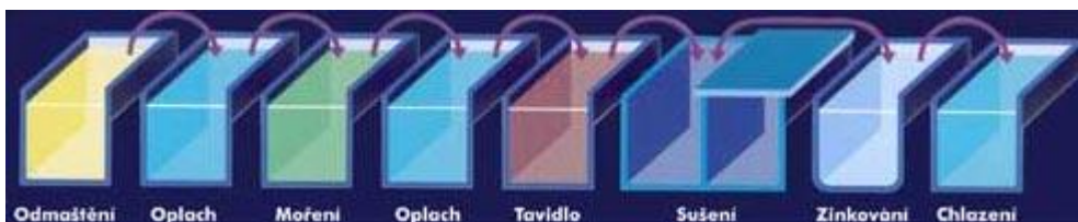
Obrázek 3: Proces žárového zinkování ( http://www.alphaunion.cz/nabidka/zarove-zinkovani )
