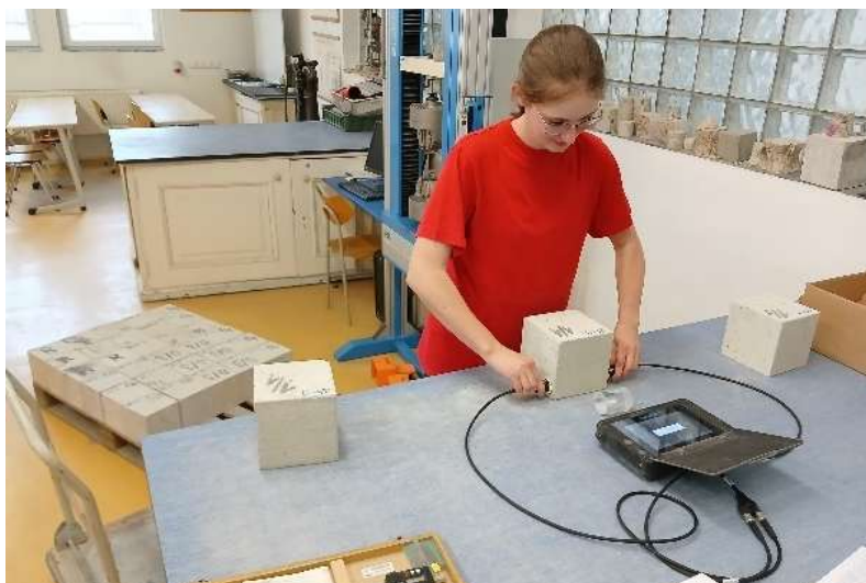
Obr. 14 Měření doby průchodu ultrazvuku na krychli
