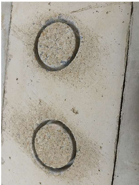
Obr.A. 6 Vyvrtané vývrty na blocích R vlevo a 1/3
