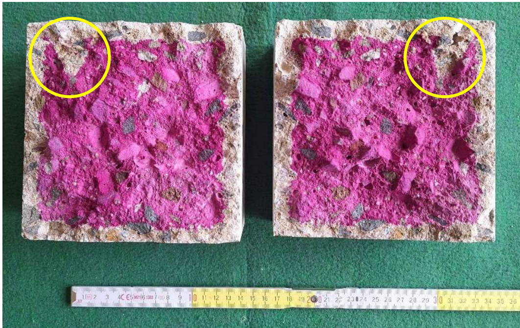
Obr. 39 Hloubka karbonatace po 28 dnech v karb. komoře – beton 0/2
