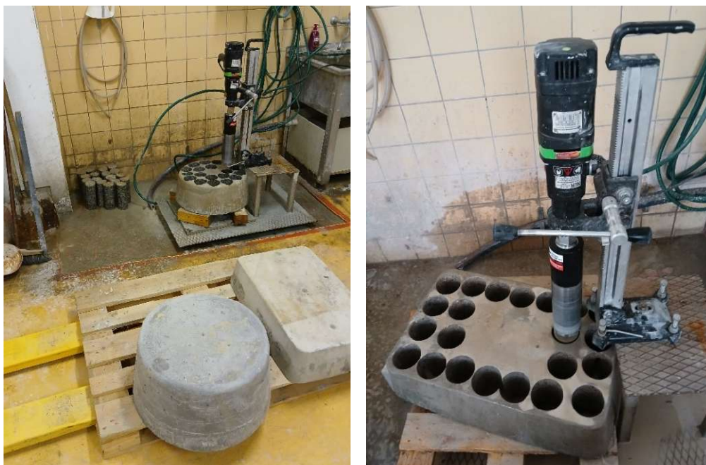
Obr. 51 Vrtání vývrtů z betonových bloků
