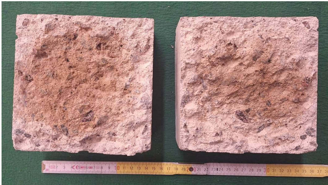
Obr. 41 Hloubka karbonatace po 90 dnech v karb. komoře – beton R
