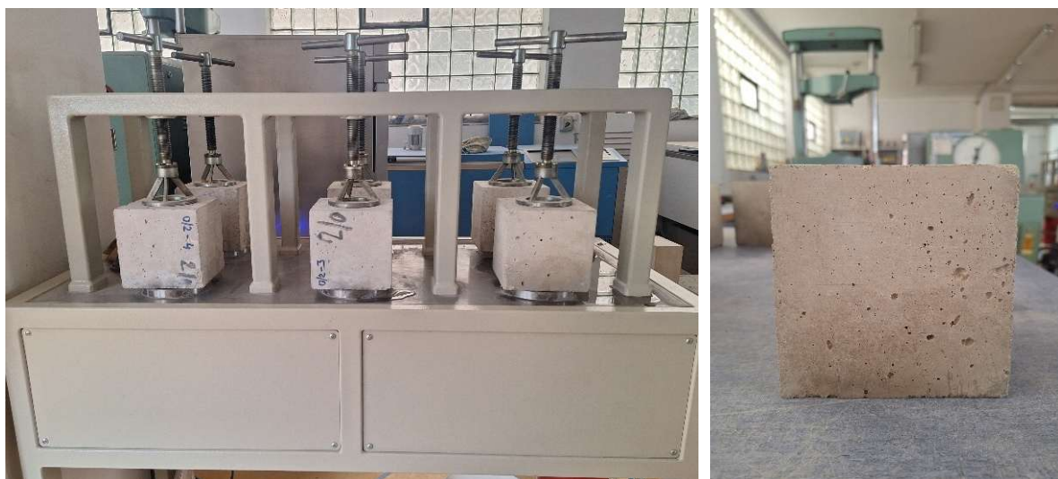
Obr. 5 Vlevo tělesa upnutá ve zkušebním zařízení, vpravo viditelná linie průsaku na boku krychle 0/1-3
