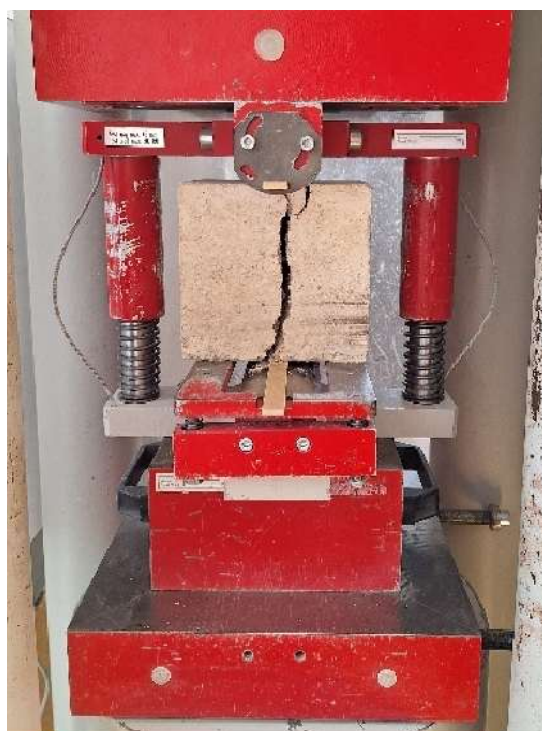
Obr. 4 Zkouška pevnosti v příčném tahu na krychli
