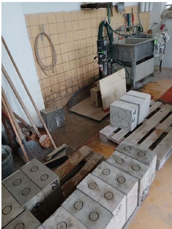
Obr.A. 5 Vrtání těles na odtrhovou zkoušku
