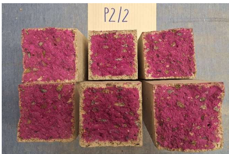
Obr. 19 Karbonatce na hranolech P2/2
