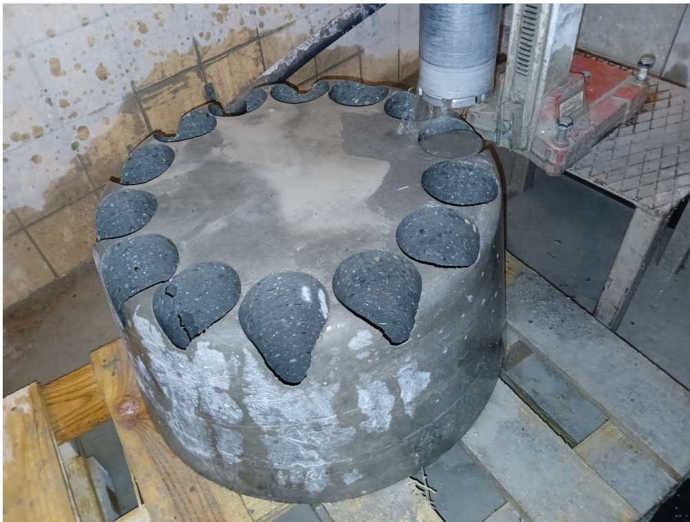
Obr.A. 10 Blok s odvrtnými vývrťy
