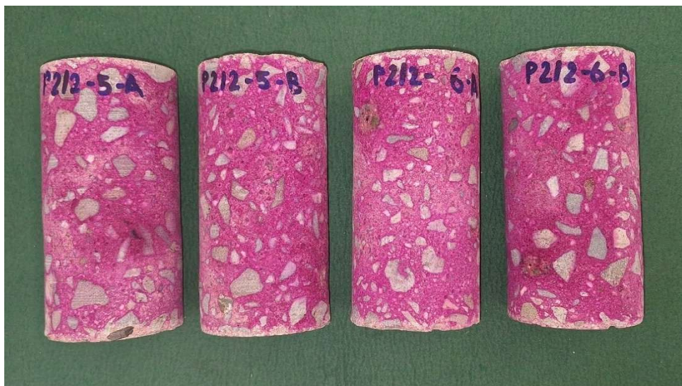
Obr. A. 39 Vývrty z krychlí P2/2-5 a P2/2-6
