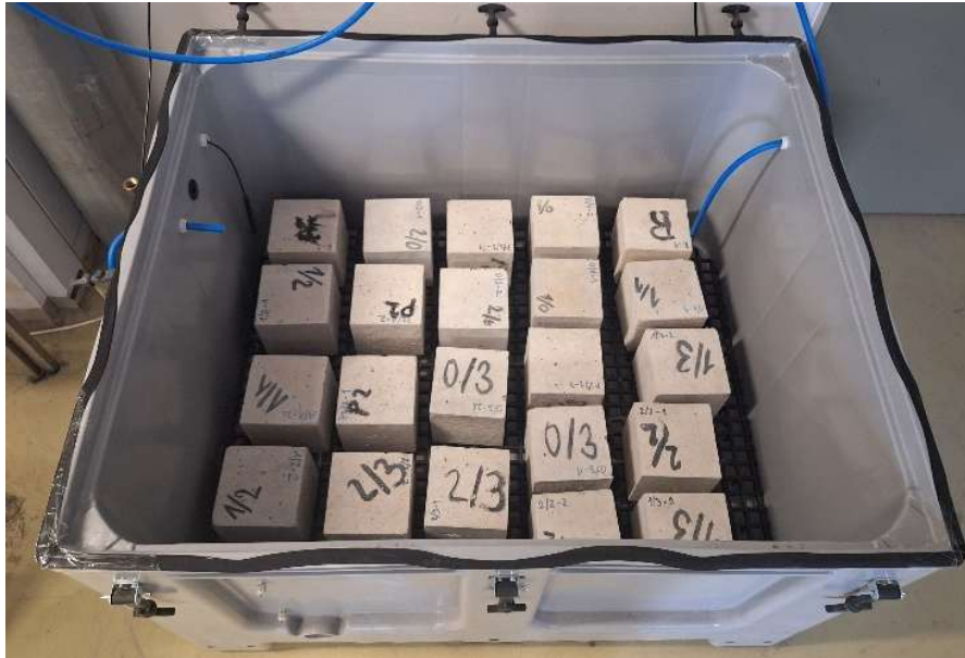
Obr. 22 Krychle uložené v karbonatační komoře
