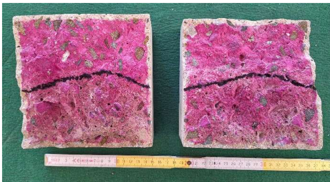
Obr. 17 Krychle 1/2-3 po stanovení současně hloubky průsaku tlakovou vodou (černá křivka) a hloubky karbonatace
