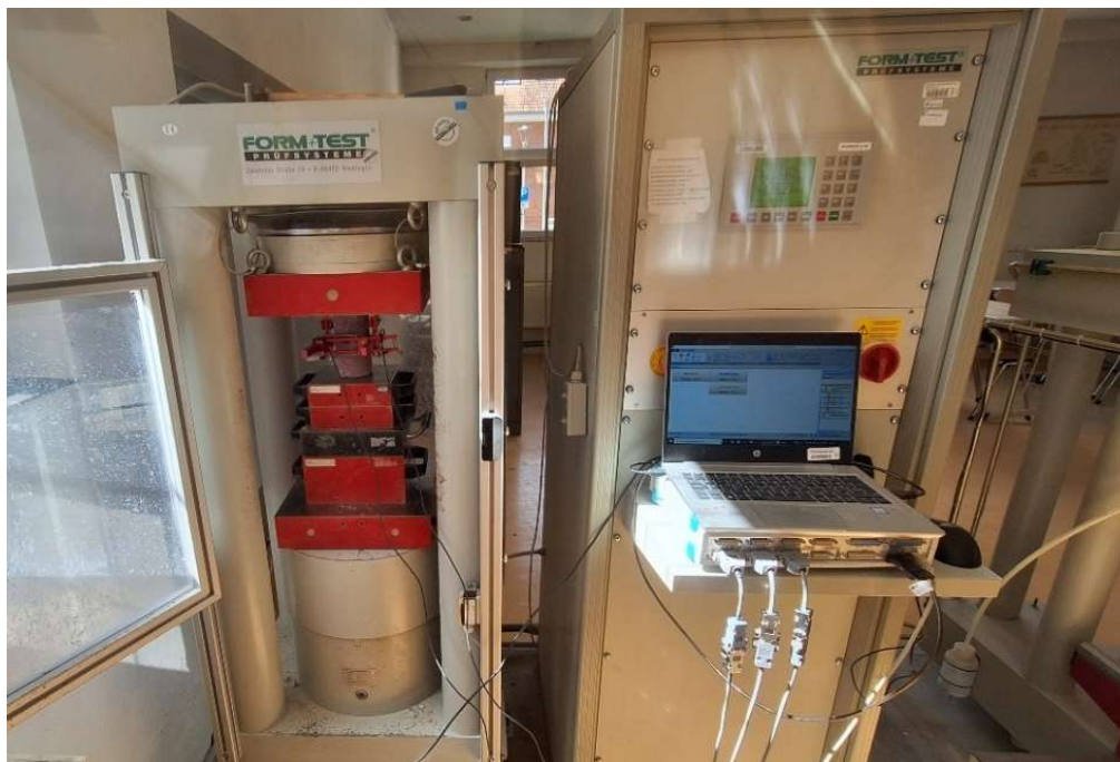
Obr. 12 Zkušební lis ALPHA 3-3000 S FORM+TEST během zkoušky statického modulu pružnosti
