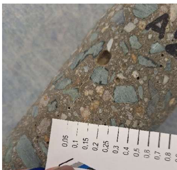
Obr. 59 Těleso A21 po 50 cyklech, C02 po 50 cyklech
