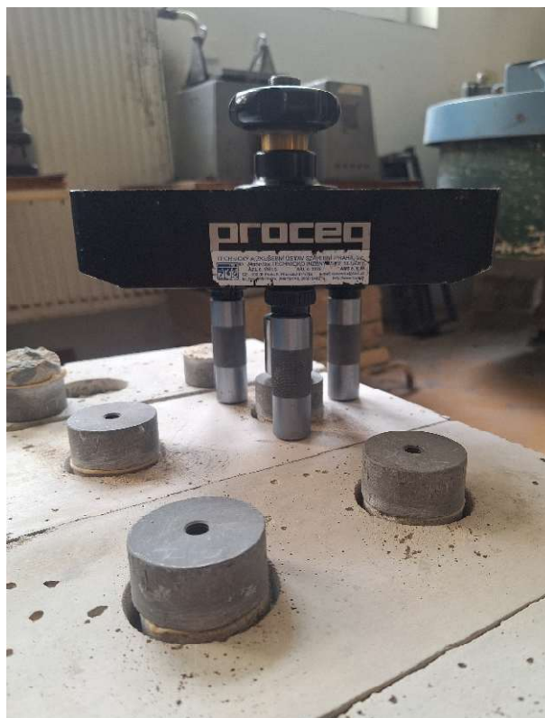
Obr. 8 Zkušební zařízení pro odtrhovou zkoušku vlevo
