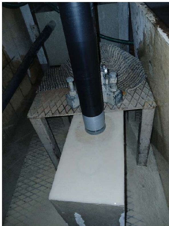
Obr.A. 5 Vrtání těles na odtrhovou zkoušku
