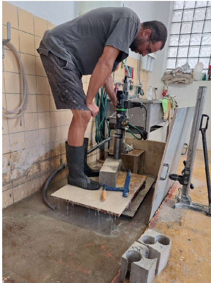
Obr.A. 1 Vrtání vývrtů z krychlí
