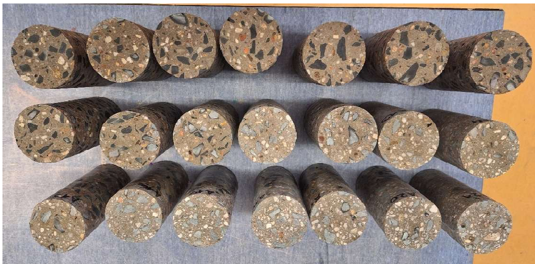
Obr. 57 Tělesa betonu A po vyjmutí z mrazicího zařízení po 50 cyklech
