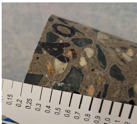
Obr. 58 Vlevo těleso A01 po 50 cyklech, vpravo A10 po 50 cyklech
