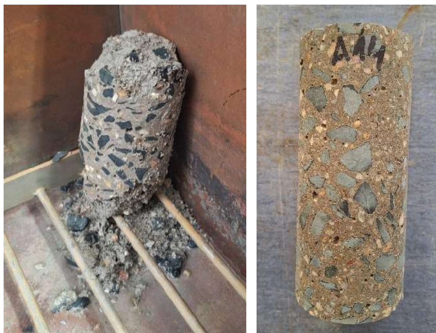
Obr. 60 Rozpadlé těleso A01 po 75 cyklech, A14 po 75 cyklech
