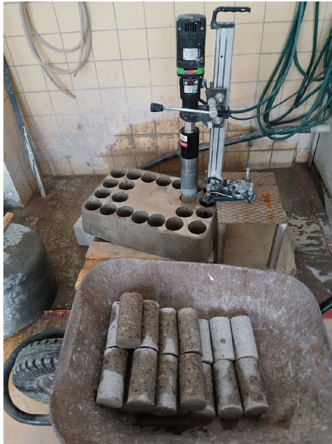
Obr.A. 9 Vrtání vývrťů
