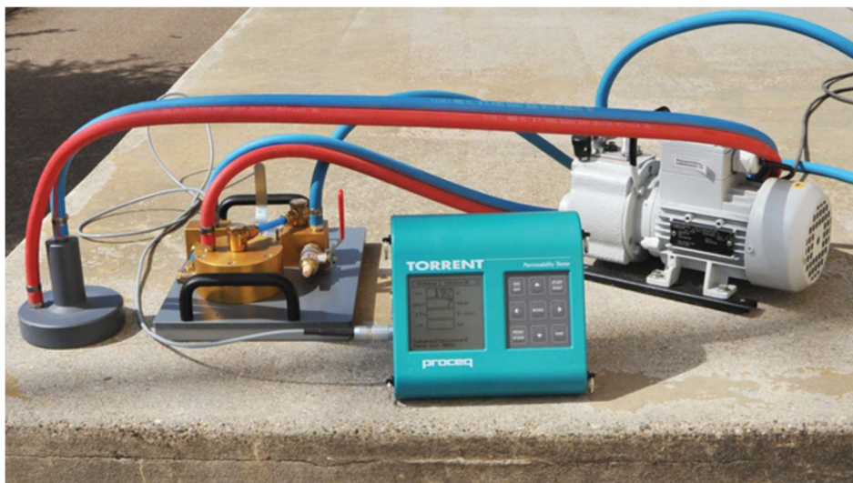
Obr. 9 Příklad přístroje TPT [32]
