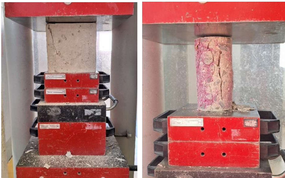
Obr. 2 Zkouška pevnosti betonu v tlaku
