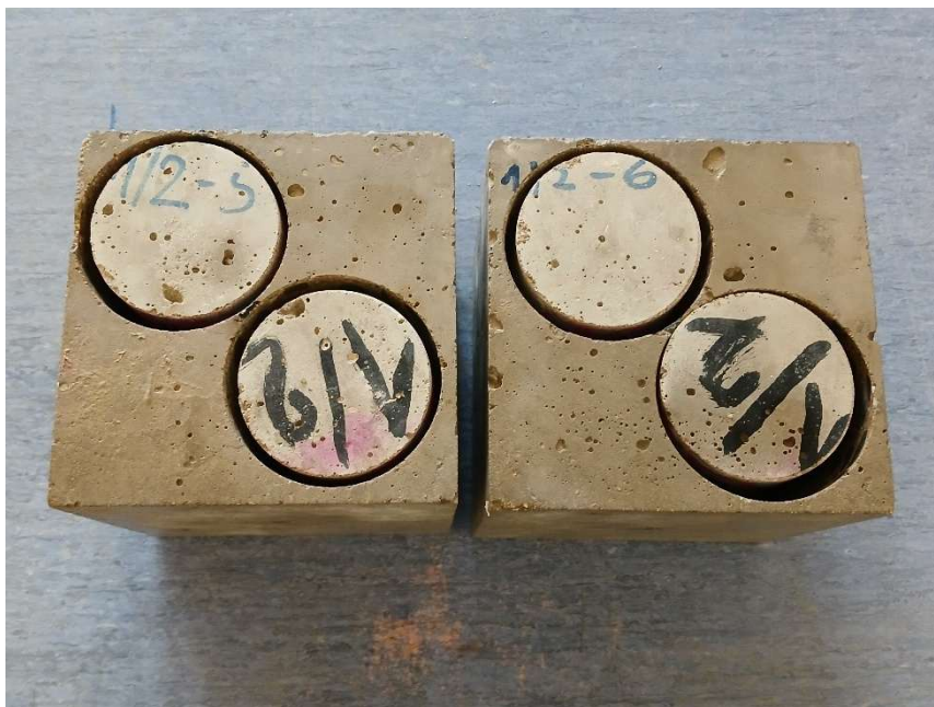
Obr.A. 2 Vyvrtané vývrty z krychlí
