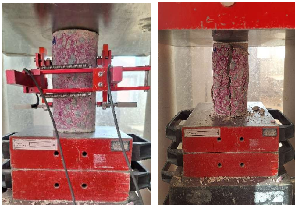
Obr. 13 Vlevo vývrt s osazenými elektronickými tenzometry Electronic Strain Transducer LD-DD1-2, vpravo zkušební lis ALPHA 3-3000 S FORM+TEST během zkoušky statického modulu pružnosti
