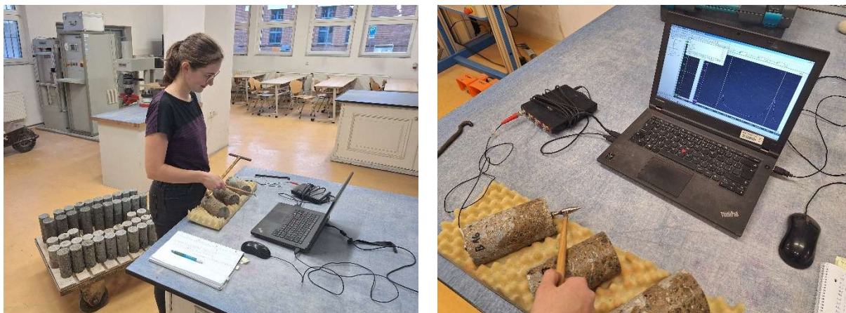
Obr. 52 Zjišťování vlastních frekvencí rezonanční metodou
