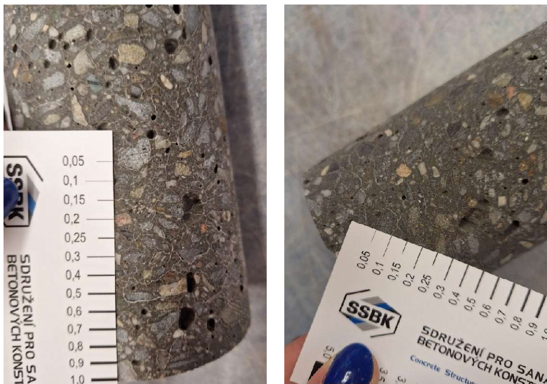
Obr.A. 15 Vývrtý C02 vlevo a C04 vpravo po 50 cyklech
