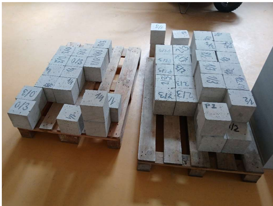
Obr.A. 4 Zkušební krychle
