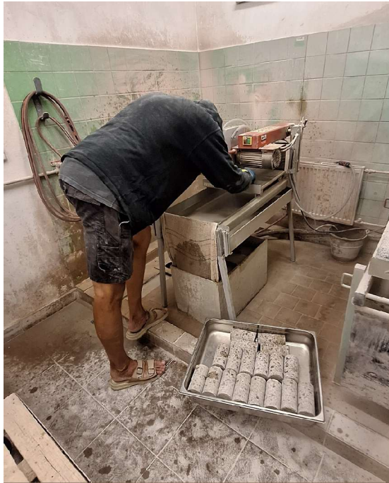
Obr.A. 11 Řezání vývrtů na přibližně stejné délky
