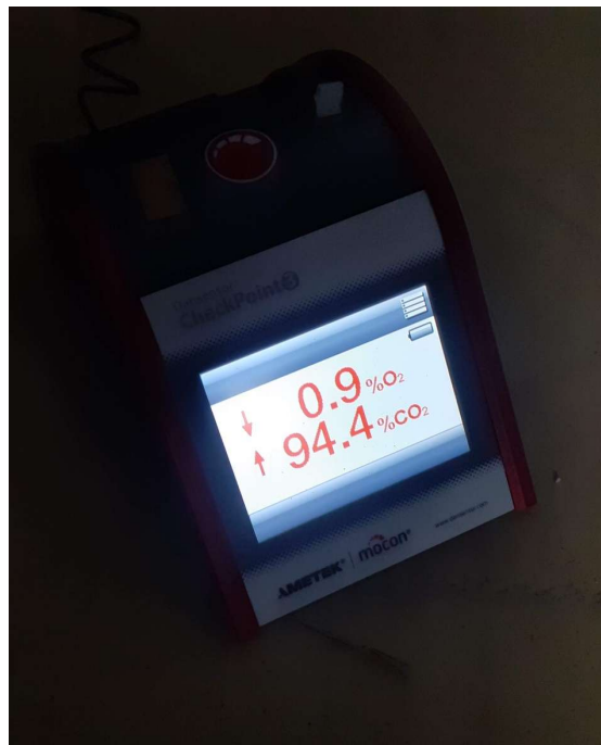
Obr.A. 8 Měření koncentrace CO 2 v karbonatační komoře
