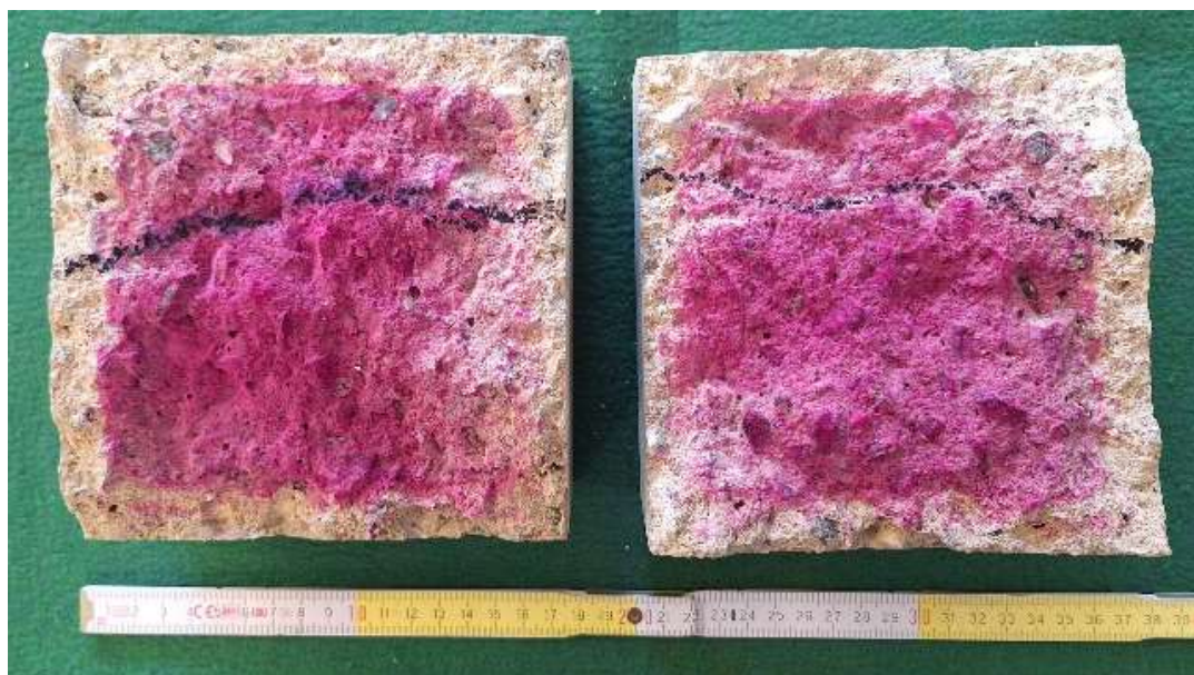
Obr. 16 Krychle R-3 po stanovení současně hloubky průsaku tlakovou vodou (černá křivka) a hloubky karbonátace
