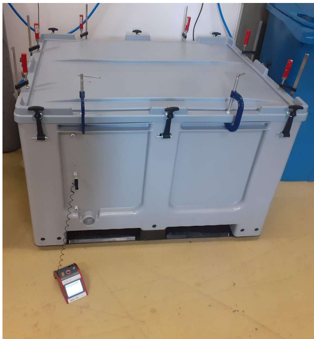
Obr.A. 8 Měření koncentrace CO 2 v karbonatační komoře
