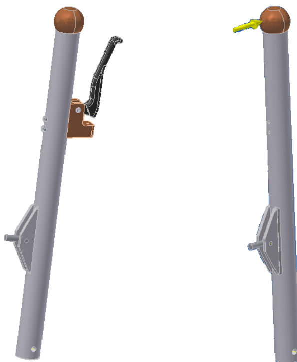
Obr.26 Model současné řadicí páky a páky pro MKP
