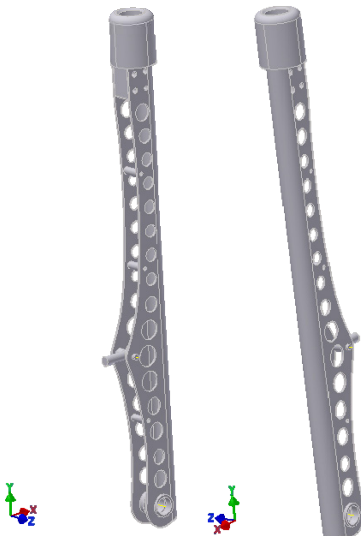
Obr.58 Tvar 6.varianty řadicí páky
