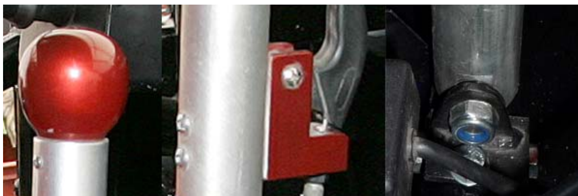
Obr.21 Detaily řadicí koule, aretace a uchycení
