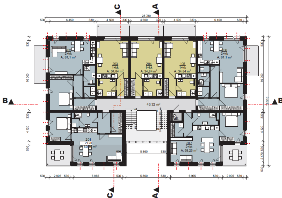
Obrázek 11: Půdorysné uspořádání druhého nadzemního podlaží [30]
