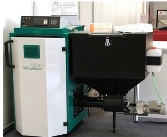
Obr. 15 Domácí automatický kotel na pelety se zásobníkem [47]
