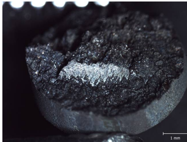
Obr. 11.3: Lomová plocha vzorku 7 (stereolupa), \epsilon_a = 0,52\% , N_f = 244 , \epsilon_{ap} = 7,17242 \cdot 10^{-4} , \sigma_a = 725,68 MPa.
