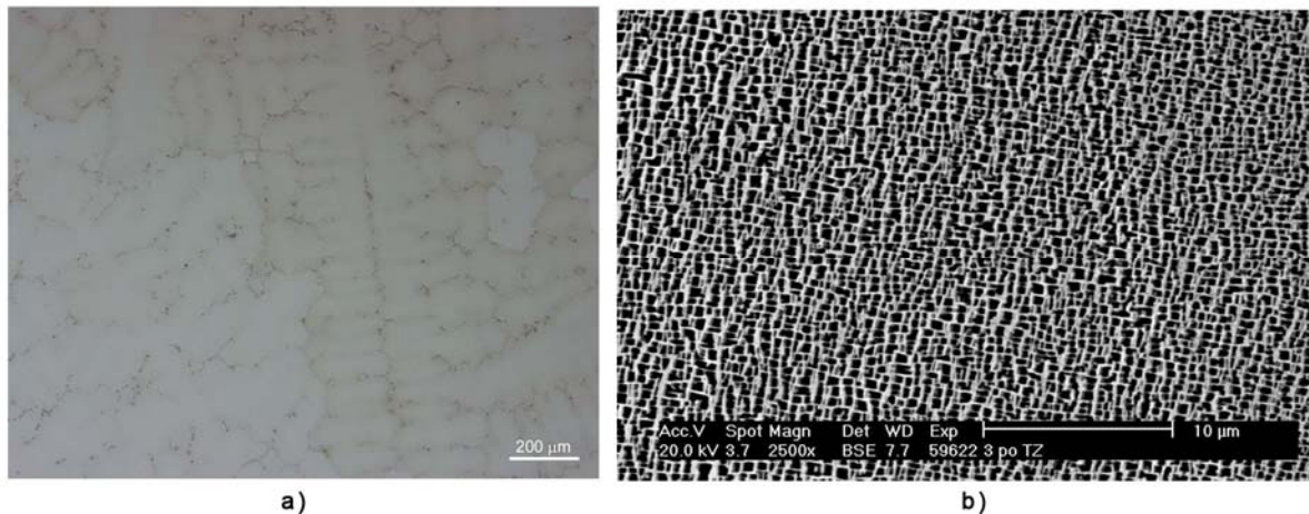
Obr. 11.16: a) Dendritická struktura vzorku 3 (SM), b) Mikrostruktura vzorku 3 - základní tuhý roztok \gamma (světlá fáze) a precipitáty \gamma' (tmavé částice) (REM)
