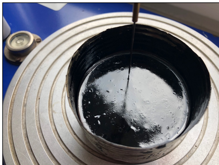
Obr. č. 35: Vytemperovaný vzorek pro stanovení penetrace jehlou
