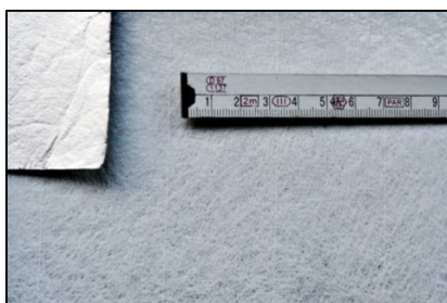
Obr. č. 7: Nosná vložka na bázi skleněné rohože s hliníkovou fólií [5]
