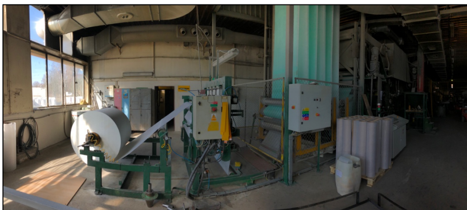
Obr. č. 10: Výrobní linka pro výrobu asfaltových pásů – odvíjení nosné vložky z role, kompenzátor, nanášecí linka
