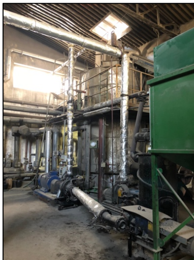
Obr. č. 9: Míchací zařízení pro homogenizaci asfaltové směsi o výkonu 30 ot./min.
