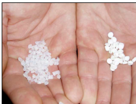
Obruč. 8: Modifikátory APP (vlevo) a SBS (vpravo) [5]
