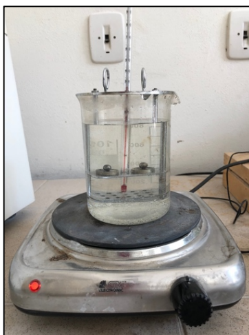
Obr. č. 21: Aparatura pro stanovení bodu měknutí
