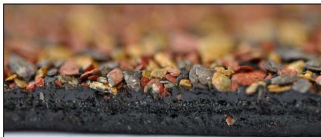
Obr. č. 2: Detail asfaltového pásu s hrubozrnným minerálním posypem [5]
