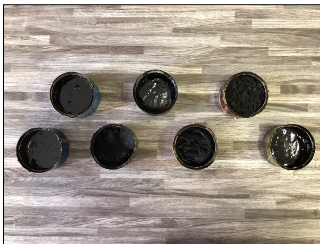
Obr. č. 34: Vzhled mastixů D, F, C, B, G, H, E (zleva)
