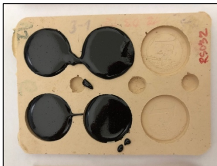
Obr. č. 32: Připravený vzorek mastixu silikonové formě
