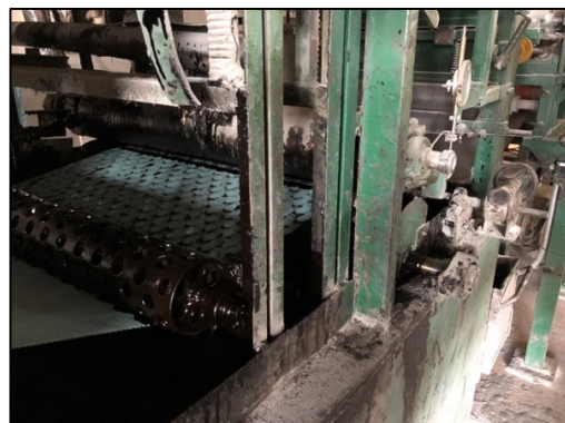
Obr. č. 12: Výroba asfaltového pásu – nanášení asfaltové povlakové vrstvy na nosnou vložku ve vaně za pomoci s nanášecích válců
