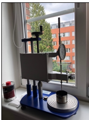
Obr. č. 22: Penetrometr pro stanovení penetrace jehlou
