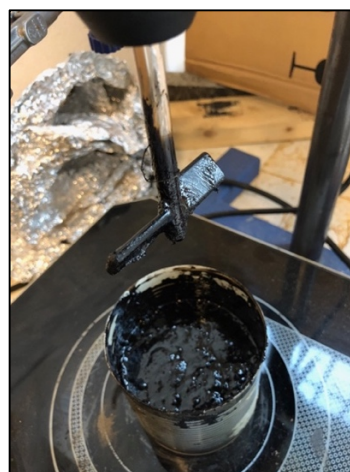
Obr. č. 25: Skleněné míchadlo upevněné v míchačce
