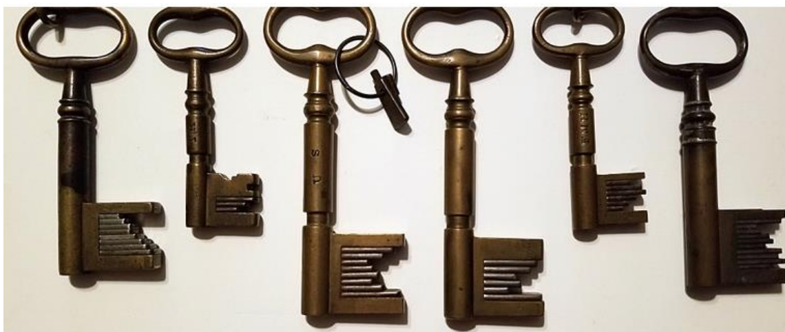
Obr. 8 Newellovy klíče s vyměnitelnými stavitky [9].
