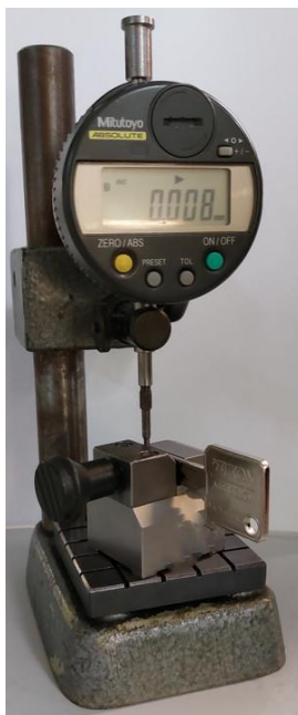
Obr. 41 Princip měření rovinnosti podřezové drážky.
