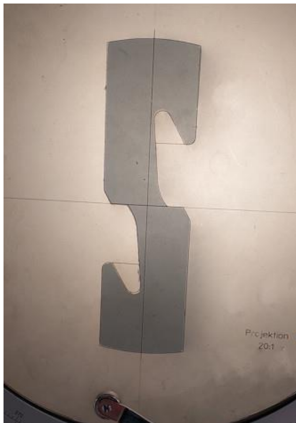
Obr. 42 Kontrola profilu klíče WSW IKON na profilprojektoru.
