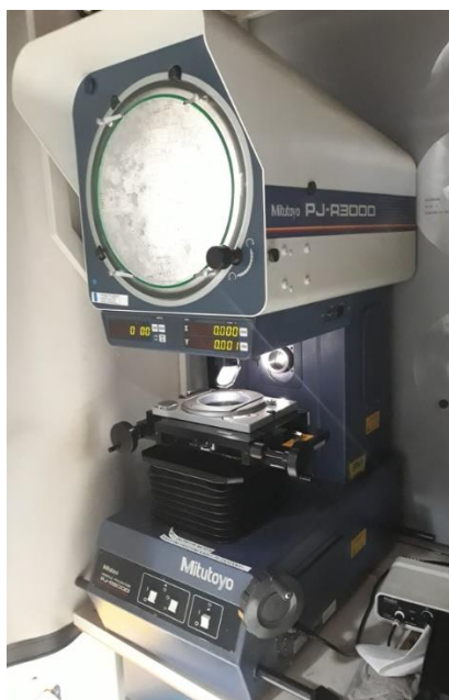
Obr. 26 Prosvětlovací přístroj na kontrolu profilu klíče.
