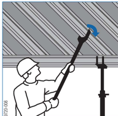
Obrázek 87 - Postup montáže bednění [28]
