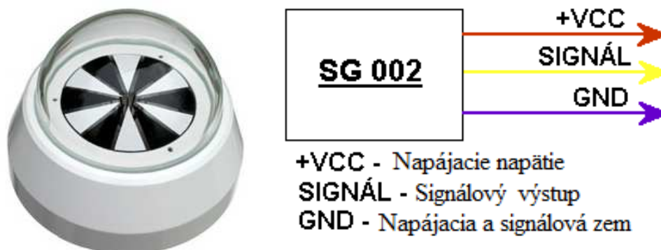
Obrázok 21 - Pyranometer SG002 a jeho schéma s označením vývodov [12]
