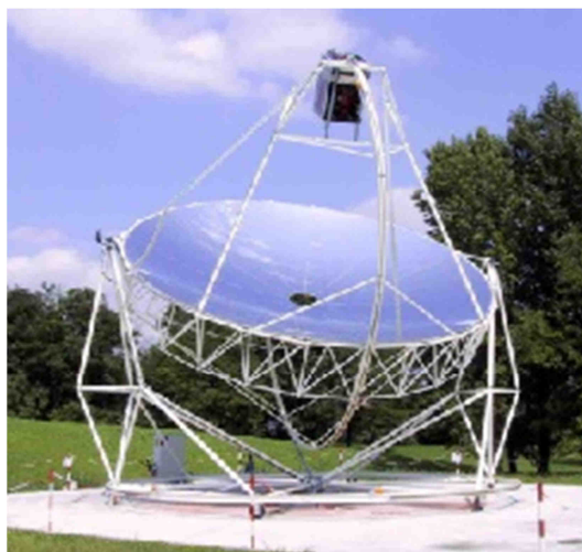
Obr. 1.7 Solární jednotka EuroDish [14]
