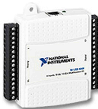
Obr. 4.1 Měřicí karta NI USB-6009
