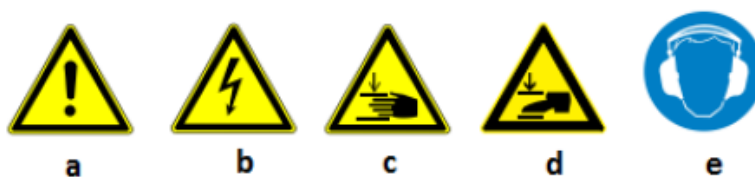
Obr. 8) Výstražné a příkazové značky. a – nebezpečí úrazu; b – pozor, elektrické zařízení; c, d – nebezpečí stisku končetiny; e – příkaz k nošení ochrany sluchu
