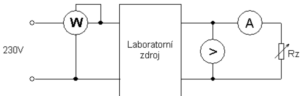
Obr. 5.18 Zapojení pracoviště pro měření účinnosti zdroje.
