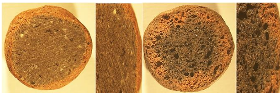
Obrázek 6: rozdílná porézní struktura zrna Liaporu, (zleva) kamenivo EC1, (zprava) kamenivo EC2, snímek elektronického mikroskopu [25]
