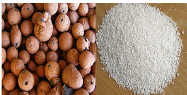
Obrázek 5: Uměle vyráběné kamenivo spékány agloporit a expandovaný perlit [57][58]
