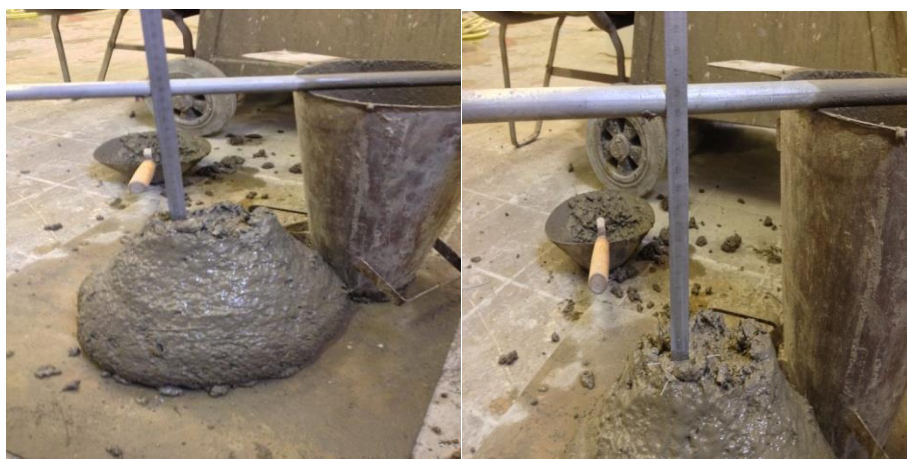
Obrázek 18 Vyhodnocení zkoušky sednutí
