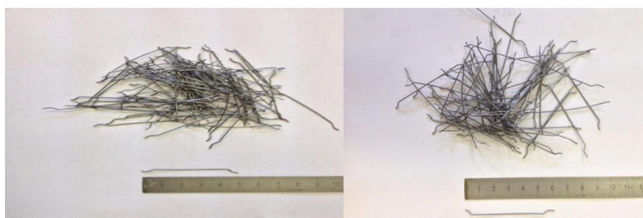
Obrázek 17: Ocelová vlákna KrampeHarex délky 50 a 60 mm, se zahnutými konci
