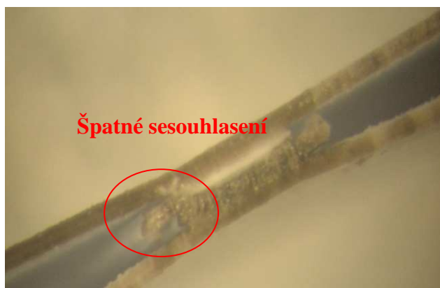
Obrázek 4.4 Defekt 3D struktury pod mikroskopem
