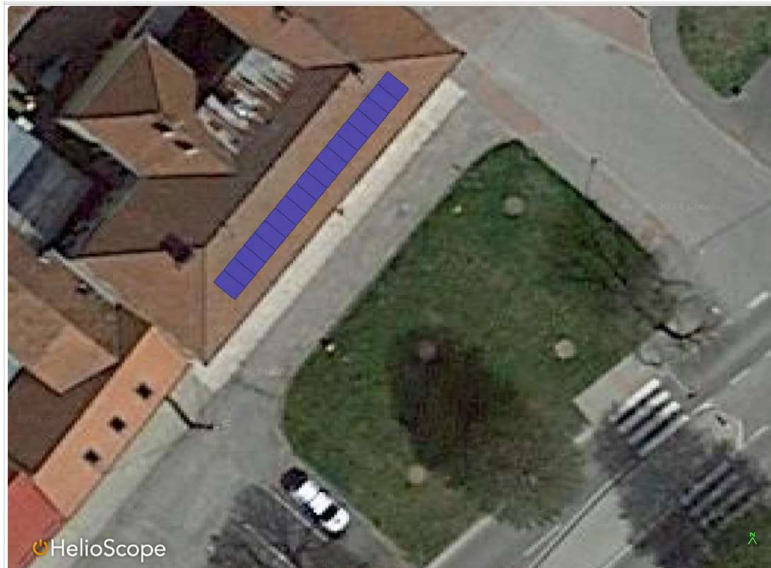
Obrázek 30 Rozmístění panelů na střechu objektu
