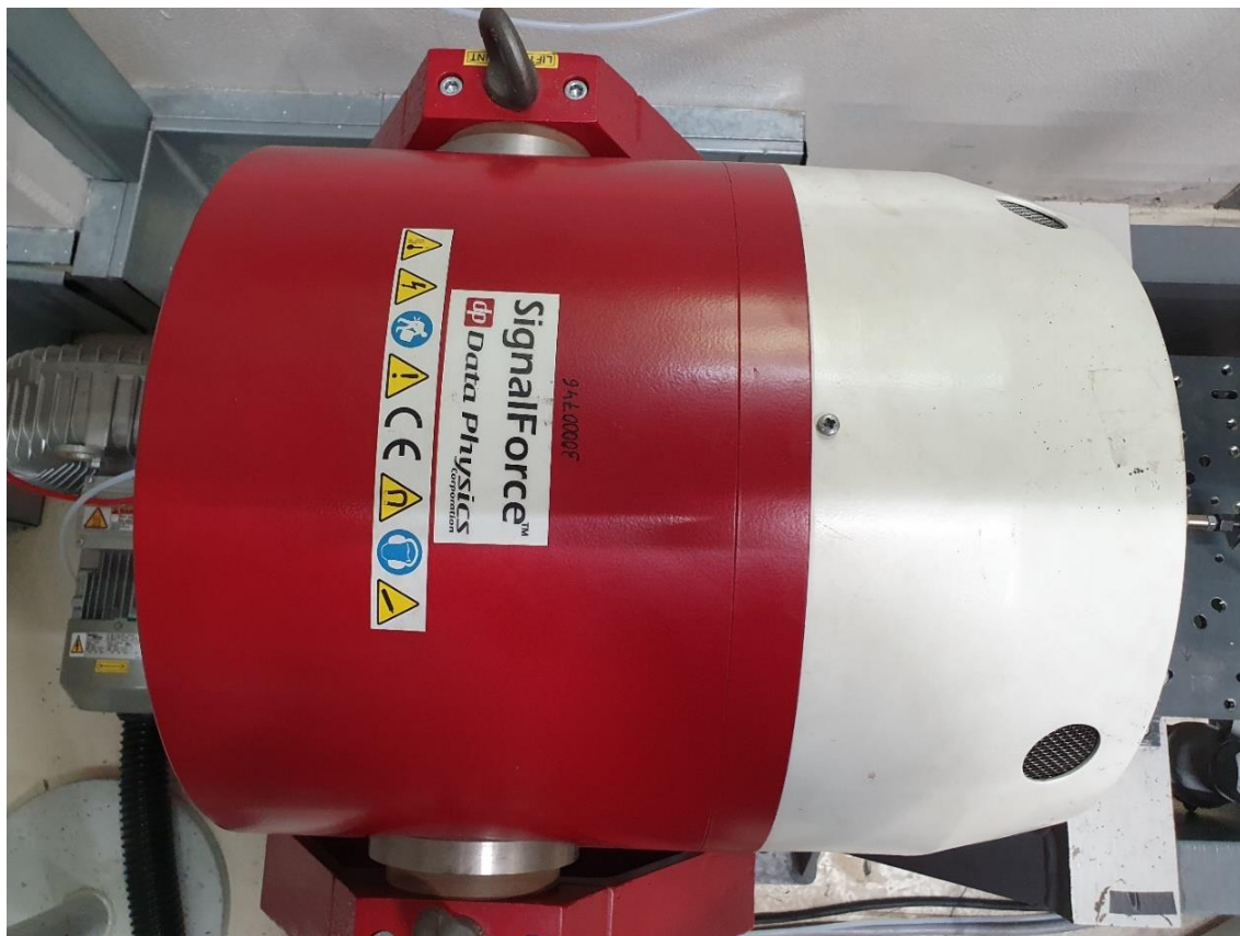
Obr. 33: Elektromagnetický vzduchem chlazený shaker Data Physics GW V-350 umístěný v motorové zkušebně v laboratoři společnosti Garrett Motion.
