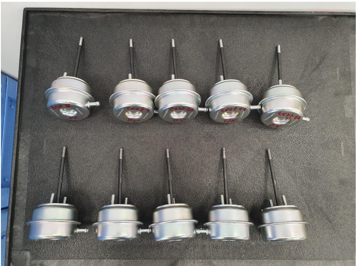
Obr. 47: Deset upravených pneumatických aktuátorů využitých pro účely experimentálního měření.
