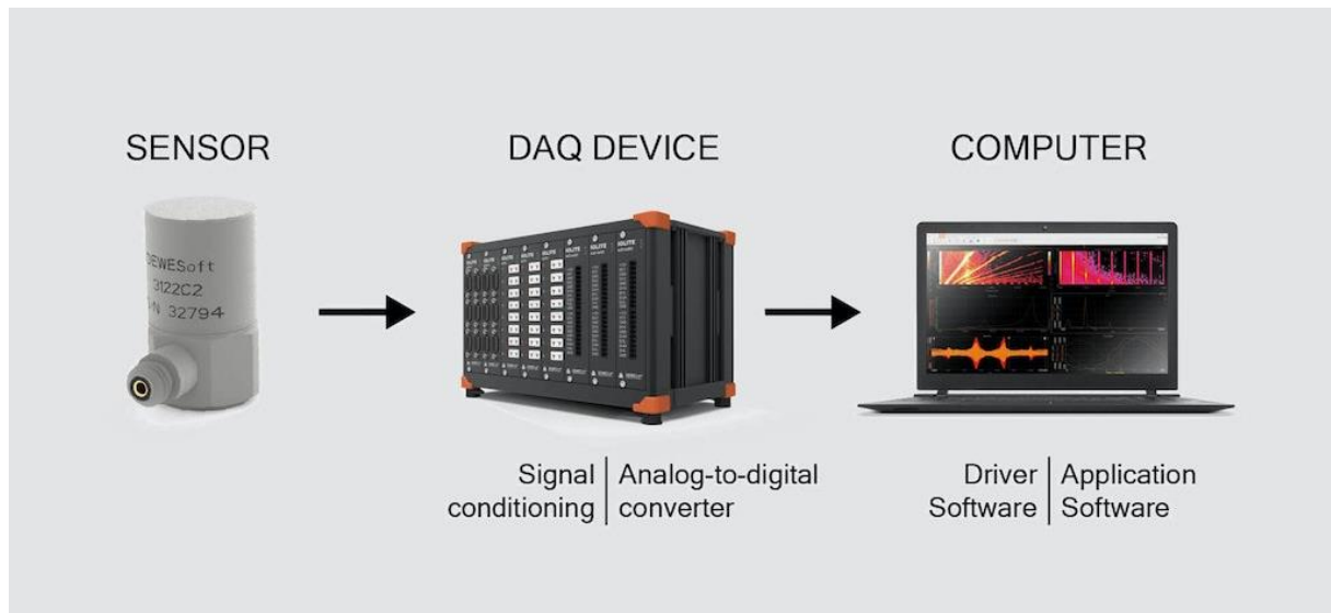
Obr. 28: Základní rozdělení měřicího procesu na: senzor, sběr dat (DAQ) a počítač se softwarem schopný naměřená data uložit a zpracovat [33].
