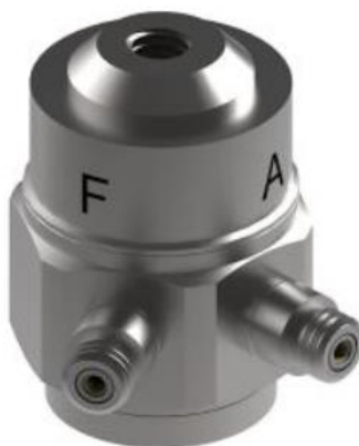
Obr. 27: Impedanční hlava od společnosti Metromatics. Písmeno F označuje výstup pro sílu, písmeno A výstup pro zrychlení [32].
