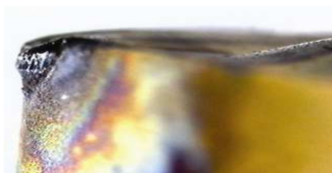
Obr. 2.22 Plastická deformace břítu nástroje [23].
