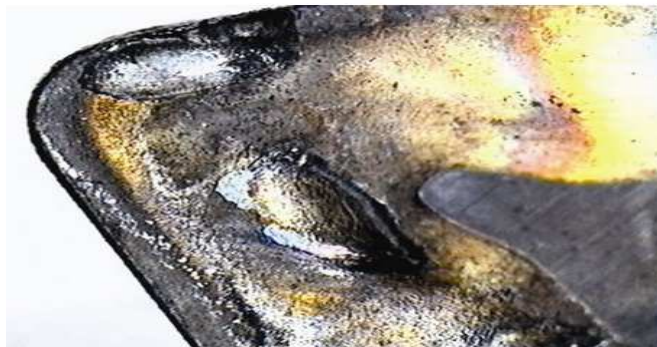
Obr. 2.24 Výmol na čele nástroje [23].
