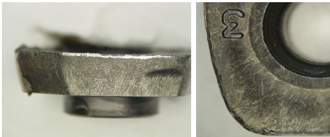
Obr. 4.27 Opotřebení při řezných podmínkách v_c=88 m/min a v_f=1000 mm/min.
