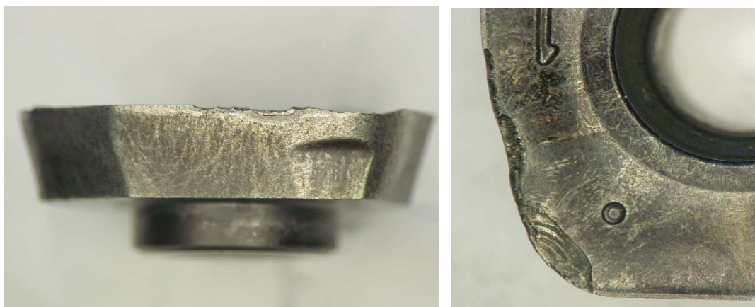
Obr. 4.28 Opotřebení při řezných podmínkách v_c=88 m/min a v_f=1250 mm/min.
