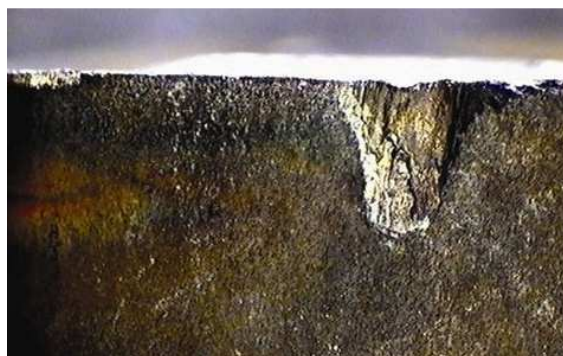
Obr. 2.27 Vylomení ostří vlivem příliš krátkých třísek [23].
