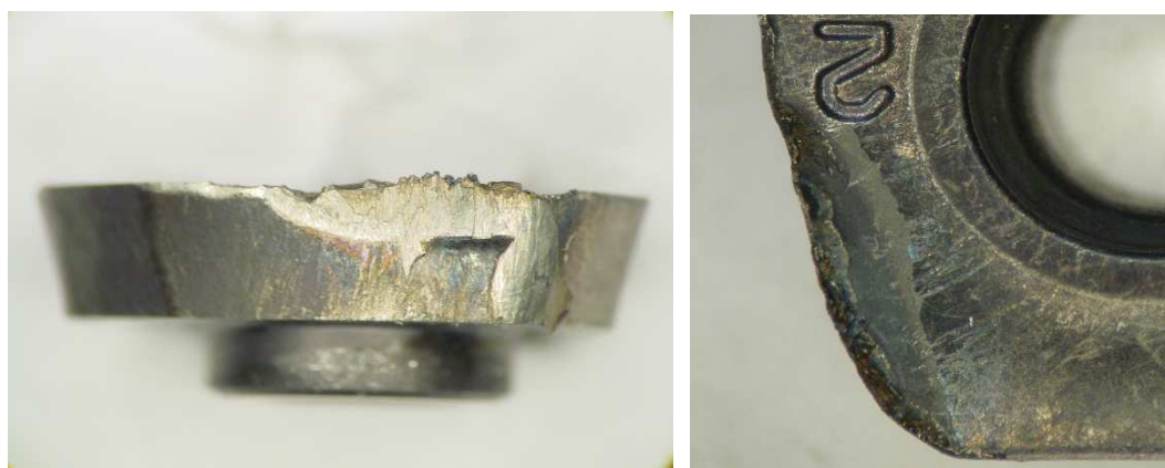
Obr. 4.29 Opotřebení při řezných podmínkách v_c=110 m/min a v_f=1600 mm/min.
