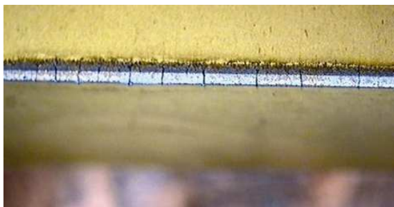
Obr. 2.26 Trhliny na ostří nástroje [23].
