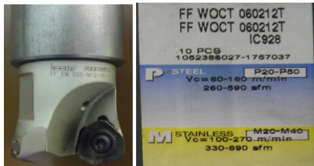
Obr. 4.4 Frézovací hlavička na upínacím trnu a doporučené řezné rychlosti pro jednotlivé třídy materiálu.
