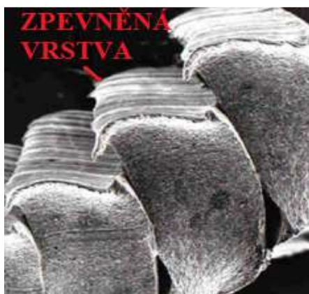
Obr. 2.9 Zpevněná povrchová vrstva, která vznikl při předchozím obrábění [20].
