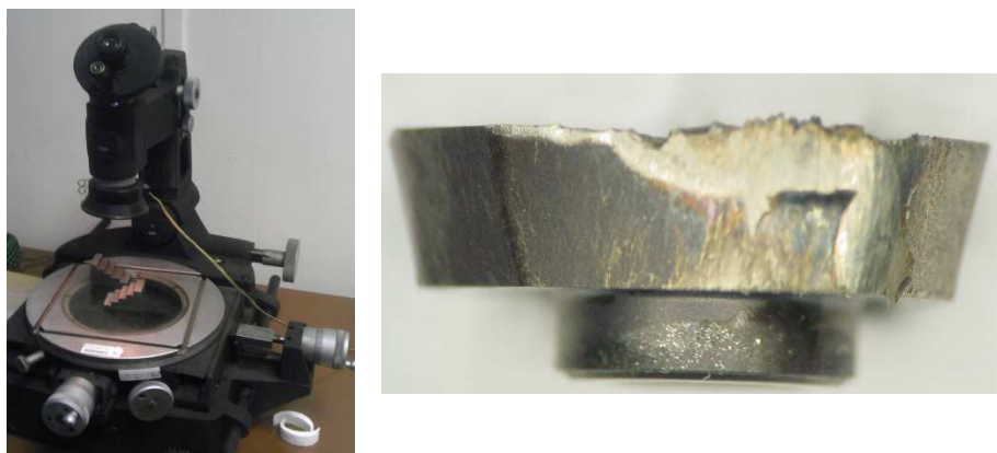
Obr. 4.9 Dílenský mikroskop a opotřebení na hřbetu VBD.
