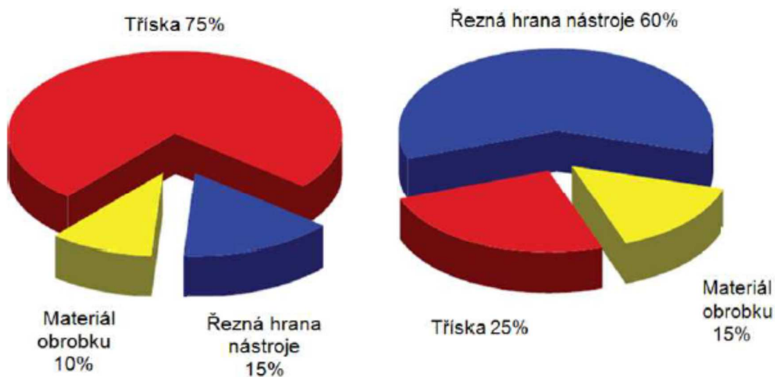
Obr. 2.3 Rozložení teploty při obrábění oceli (vlevo) a titanové slitiny (vpravo) [20].
