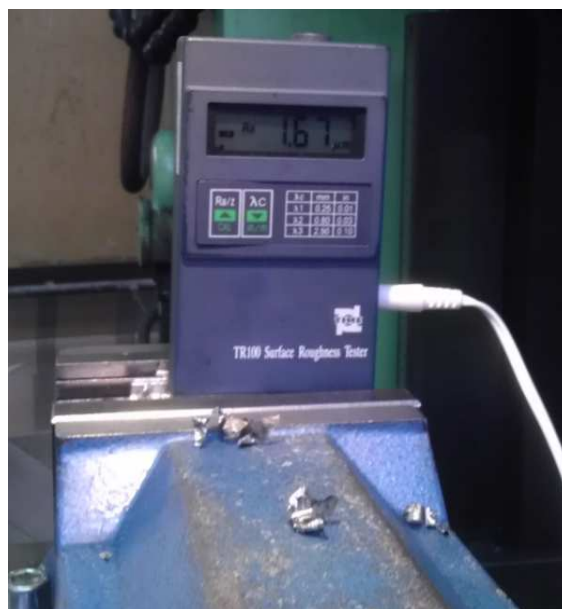
Obr. 4.8 Měření drsnosti obrobeného povrchu.
