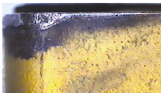
Obr. 2.19 Otěr na hřbetu nástroje [23].
