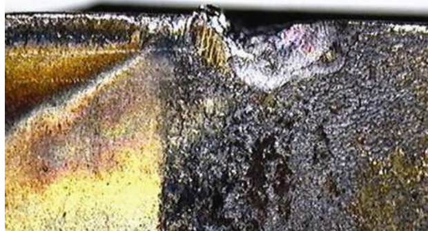
Obr. 2.25 Vrub na ostří nástroje [23].
