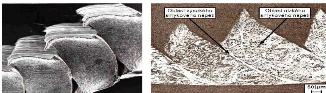
Obr. 2.7 Řezy titanovými třískami [20].
