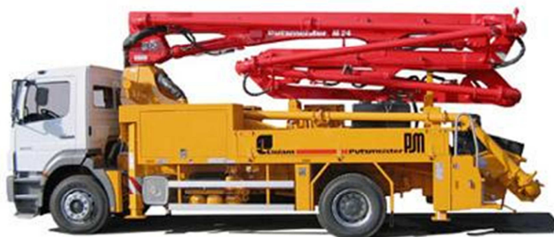
Obr. 6-9 Čerpadlo betonu Putzmeister M36-4.16 H
