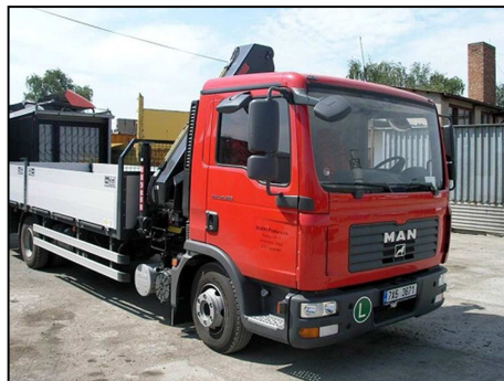
Obr. 6-7 Nákladní automobil MAN s hydraulickou rukou
