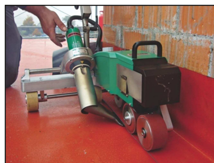
Obr. 6-15 Svářecí automat Leister VARIMAT V2
