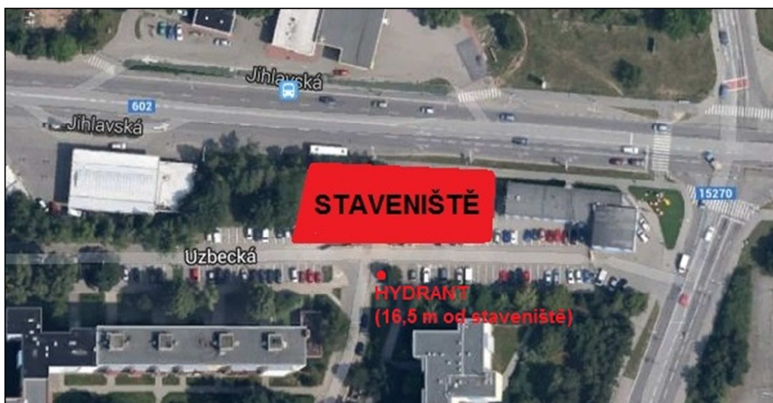
Obr. 5-2 Plocha staveniště s vyznačením polohy nejbližšího hydrantu
