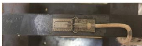
Obr. 6.7: Extenzometr P5 (MM–Vishay) detail přivaření
