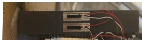
Obr. 6.5: Extenzometr P4 (TML) detail přivaření
