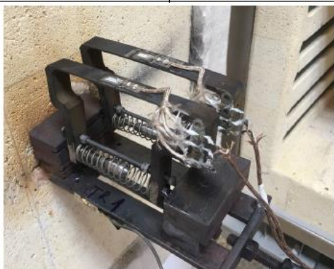
Obr. 6.6: Extenzometr P5 MM-Vishay umístěná v experimentálním zařízení (v peci)
