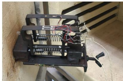
Obr. 6.4: Extenzometr P3 a P4 (TML) umístěná v experimentálním zařízení (v peci)
