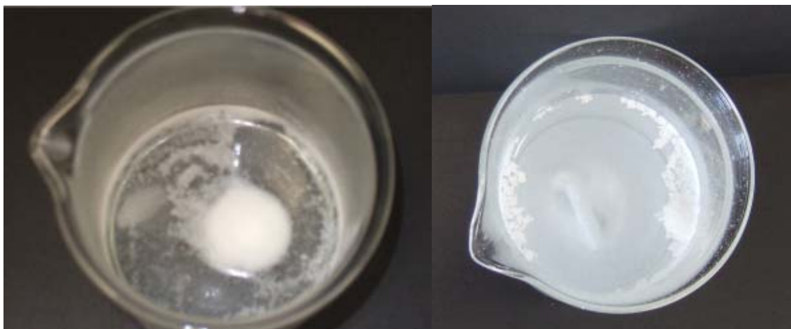
Obr. 12 : Reakční směs obsahující povrchově upravené částice \text{CaCO}_3 , vlevo – příprava 2, vpravo – příprava 4, (u dna je ještě v obou případech magnetické míchadlo).
