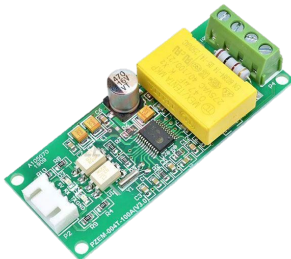
Obrázek 3.6: Ilustrační obrázek měřicího modulu PZEM-004T (bez měřicí cívky) [21]
