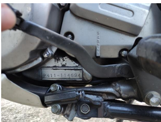
Obrázek 7 poloha řadící páky při řazení neutrálu z 1
