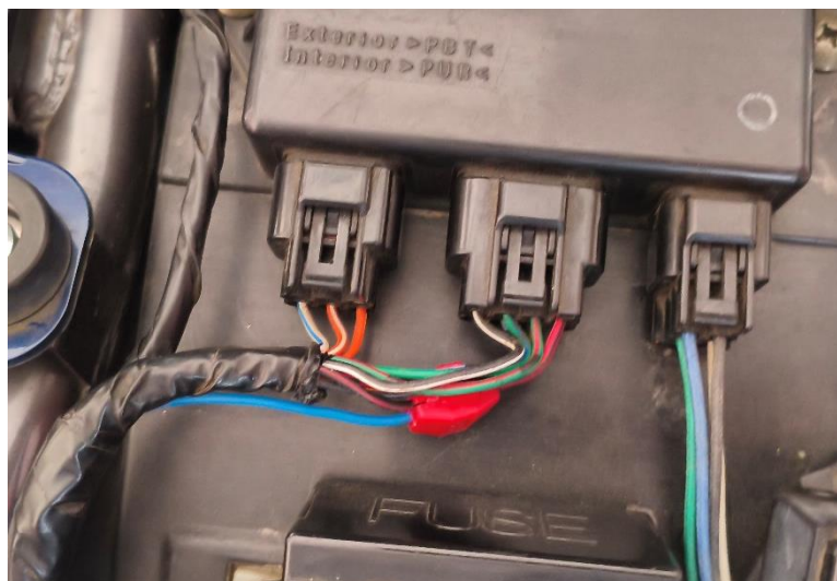
Obrázek 40 příklad napojení vodiče na instalaci motocyklu (červený konektor)
