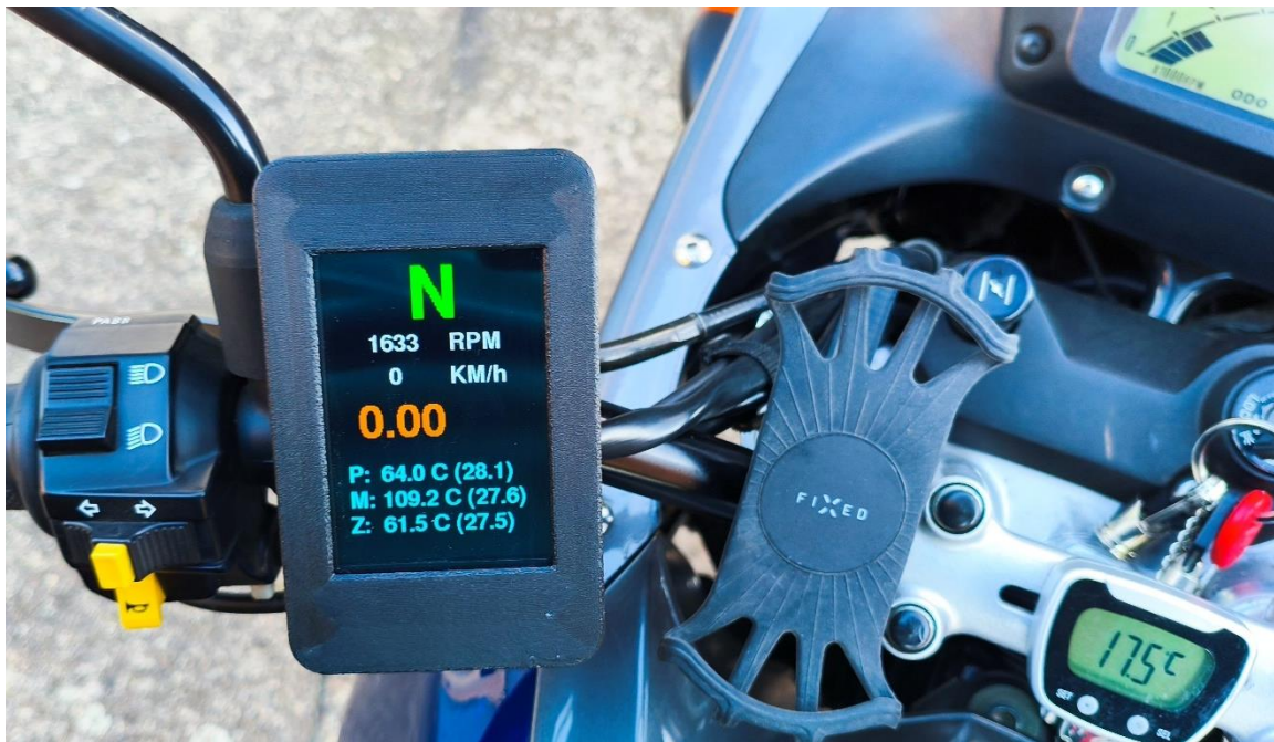
Obrázek 50 funkční zařízení při nastartovaném motocyklu a provozních teplotách
