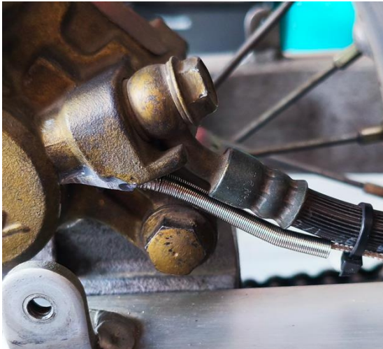
Obrázek 41 uchycení termočlátku na zadním třmenu
