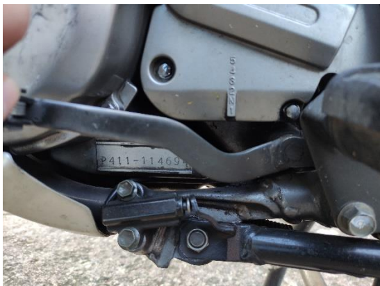
Obrázek 5 poloha řadící páky při řazení dolů
