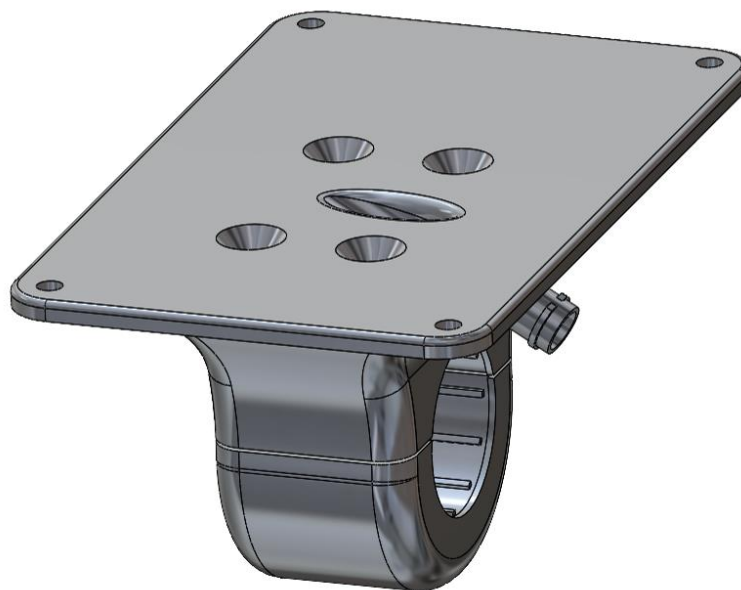
Obrázek 38 protikus uchycení displeje ve 3D
