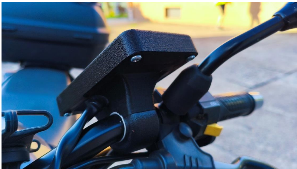
Obrázek 39 finální uchycení displeje na motocyklu
