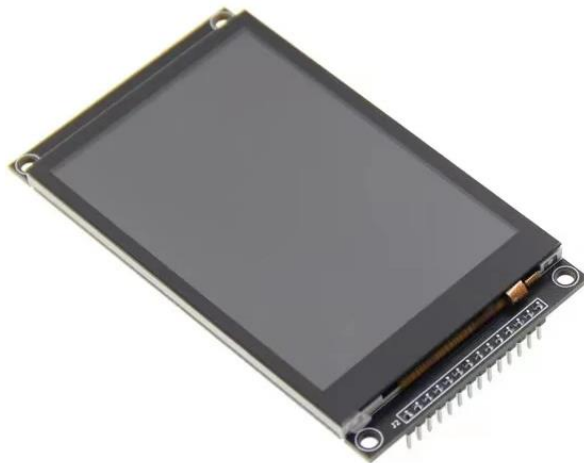
Obrázek 9 použitý 3,5“ IPS displej [9]
