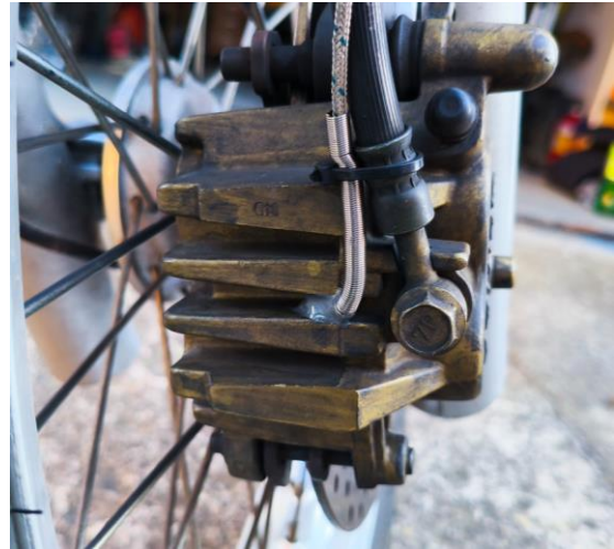
Obrázek 42 uchycení termočlátku na předním třmenu
