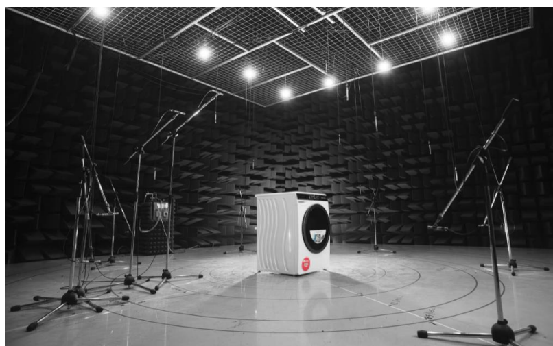
Obr. 2-7 Vymedzenie pologuľovej meracej plochy [8]
