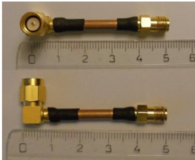
Obr. 91 Vyrobený koaxiální kabel SMA/SMA, rozměr v mm
