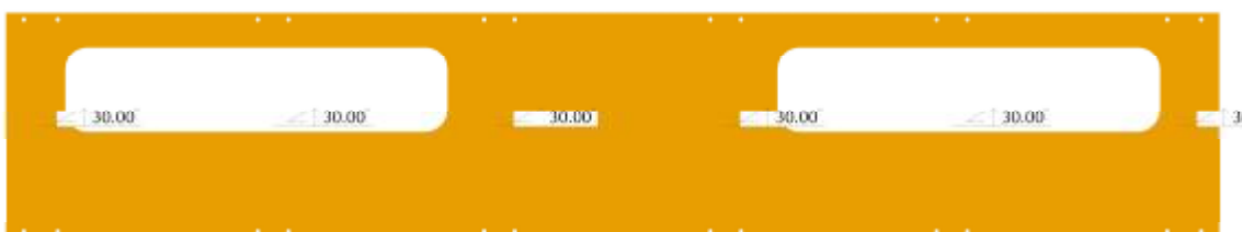
Obr. 32 Rozvinutý plech: Kryt boční horní před ohraněním
