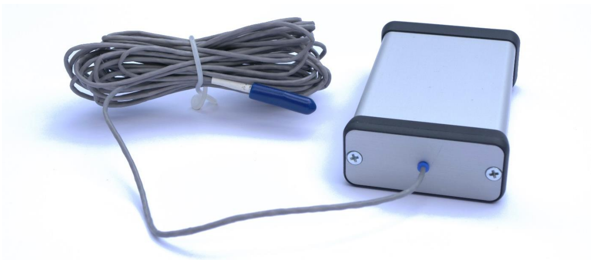
Obr. 5.3: Fotografie výsledného zařízení pro měření rychlosti vzduchu
