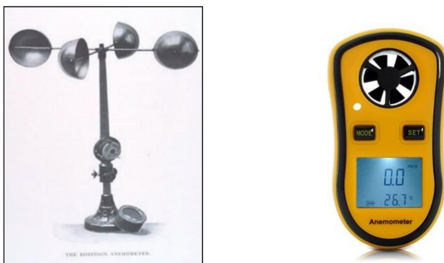
Obr. 2.1: Robinsonův lopatkový anemometr (vlevo), Digitální vrtulový anemometr (vpravo)
