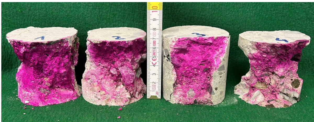
Obr. 56: Stanovenie miery karbonatizácie na skúšobných telesách N1 až N4 po skúške v tlaku.
