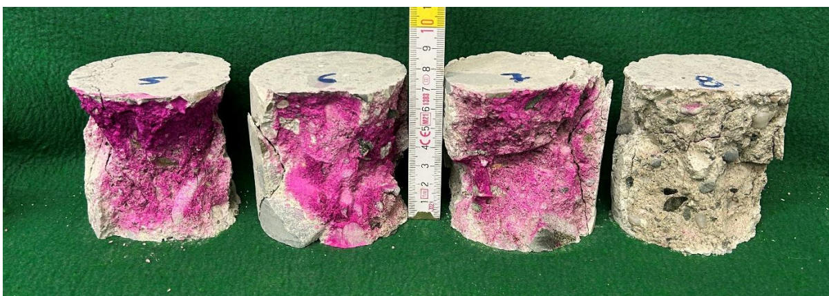
Obr. 57: Stanovenie miery karbonatizácie na skúšobných telesách N5 až N8 po skúške v tlaku. Vzorka
