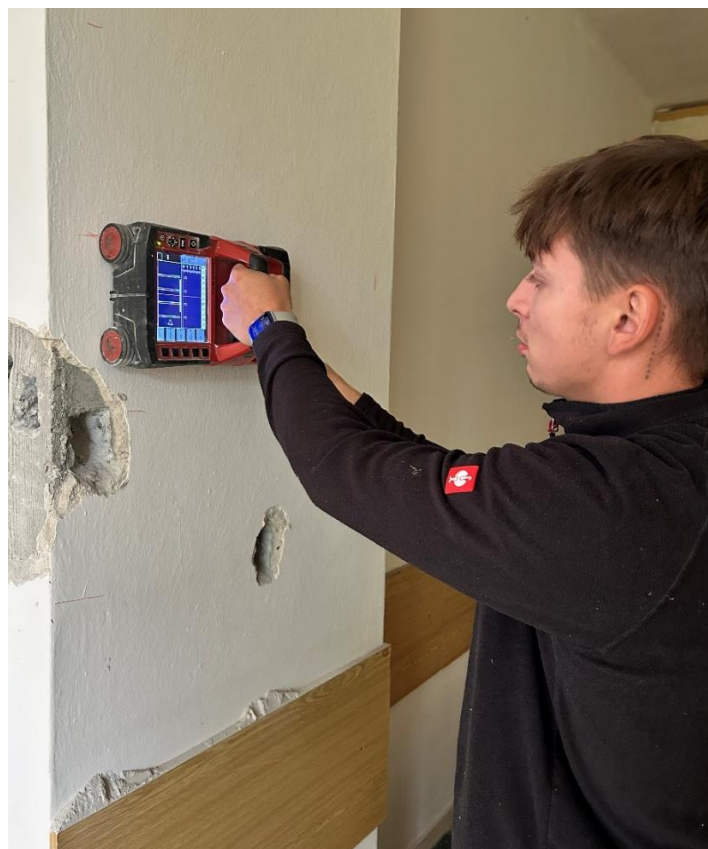
Obr. 3: Meranie obdĺžnikového stĺpu pomocou Hilti PS 1000 X-Scan.
