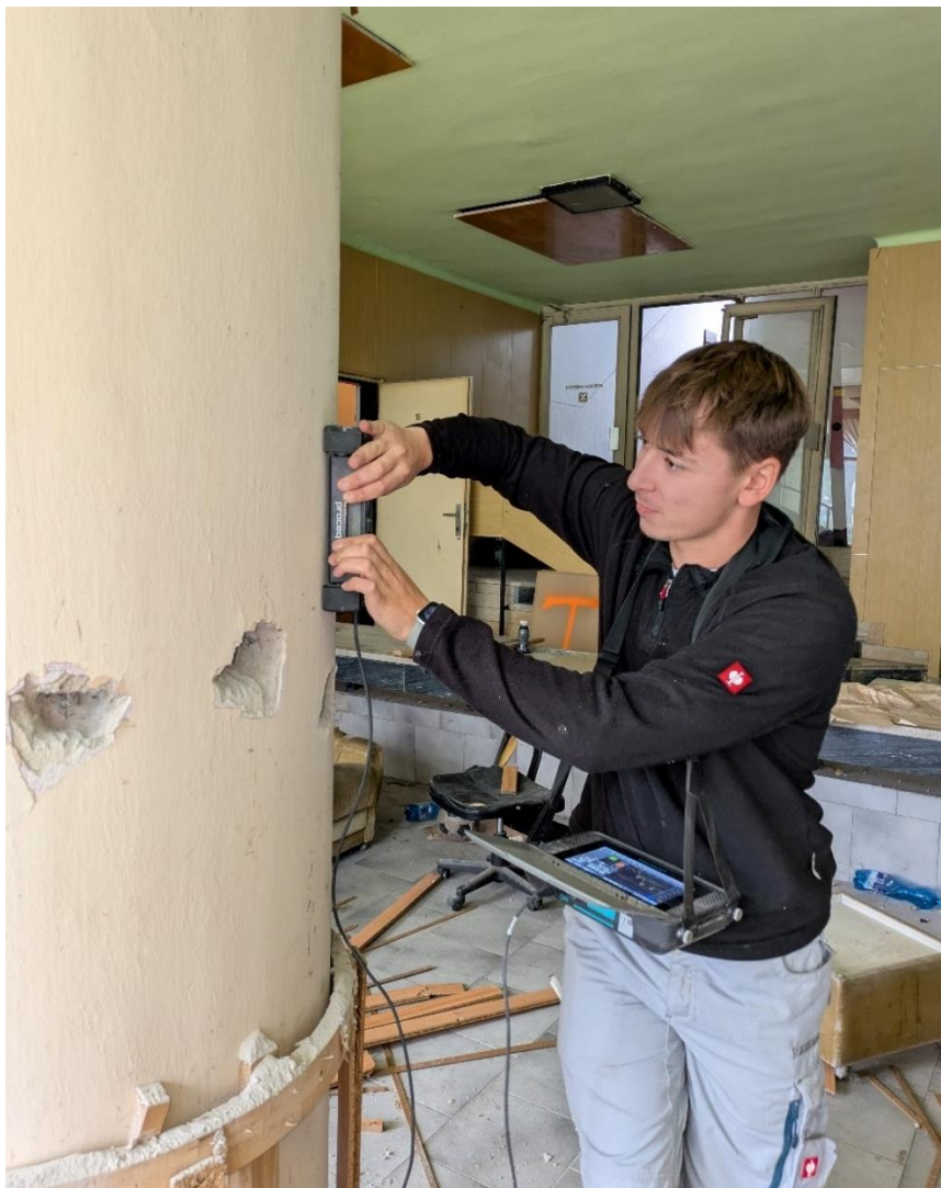
Obr. 7: Meranie kruhového stĺpu pomocou Profometer PM – 630.
