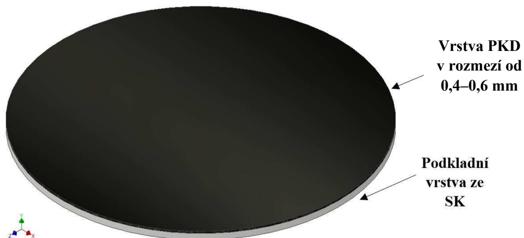
Obr. 2.7 Polotovar ve tvaru disku (průměr 76 mm a tloušťka 2 mm) pro řezání destiček z PKD.
