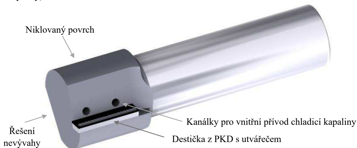
Obr. 4.6 3D model experimentální frézy.
