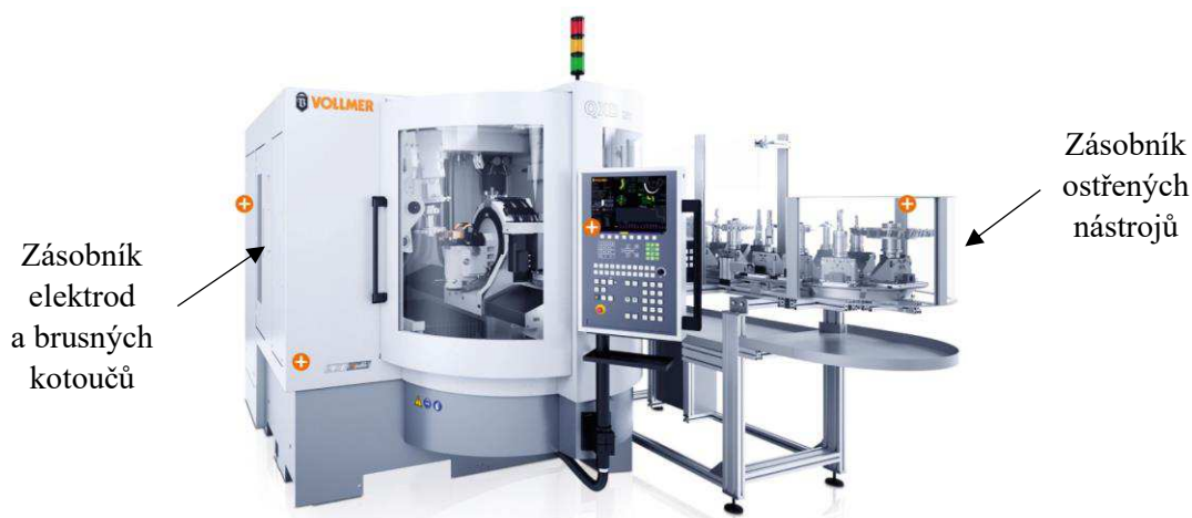
Obr. 3.3 Automatický erozivní stroj Vollmer QXD 250 se zásobníkem nástrojů a zásobníkem elektrod a brusných kotoučů [51].
