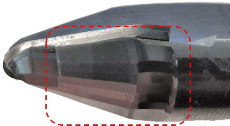
Obr. 4.90 Opakované odbroušení SK tělesa DP frézy, které třelo o obrobený povrch.
