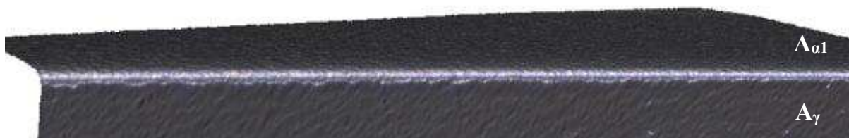
Obr. 4.121 Břit nástroje ostřený technologií LASER analyzovaný pomocí optického měřicího systému Alicona InfiniteFocusG5 (zvětšení 10×).
