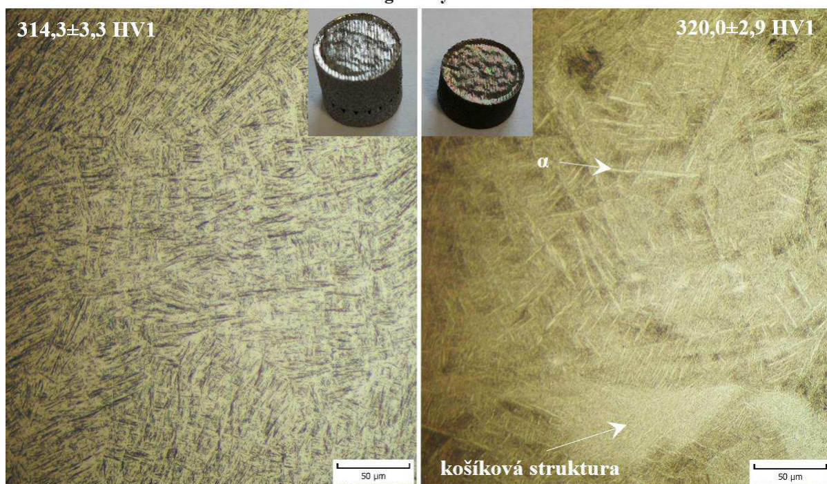
Obr. 4.85 Mikrostruktura 3D tisku – martenzitické jehlicovitá struktura \alpha' .
