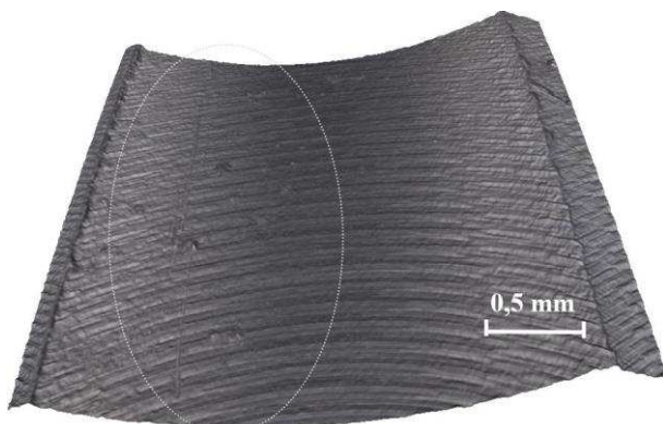
Obr. 4.82 Digitalizace obrobeného povrchu s vyznačenými nečistoty na straně nesouměrného frézování při naklonění nástroje vůči obrobku 30^\circ . Krok experimentu č. 2: n = 3183 \text{ min}^{-1} ; f_z = 0,04 \text{ mm} ; \beta_t = 30^\circ ; nástroj – HC.
