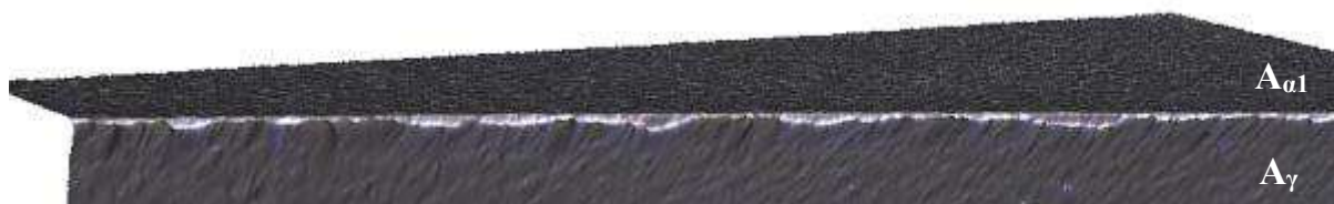
Obr. 4.122 Břit nástroje ostřený technologií WEDM analyzovaný pomocí optického měřicího systému Alicona InfiniteFocusG5 (zvětšení 10×).
