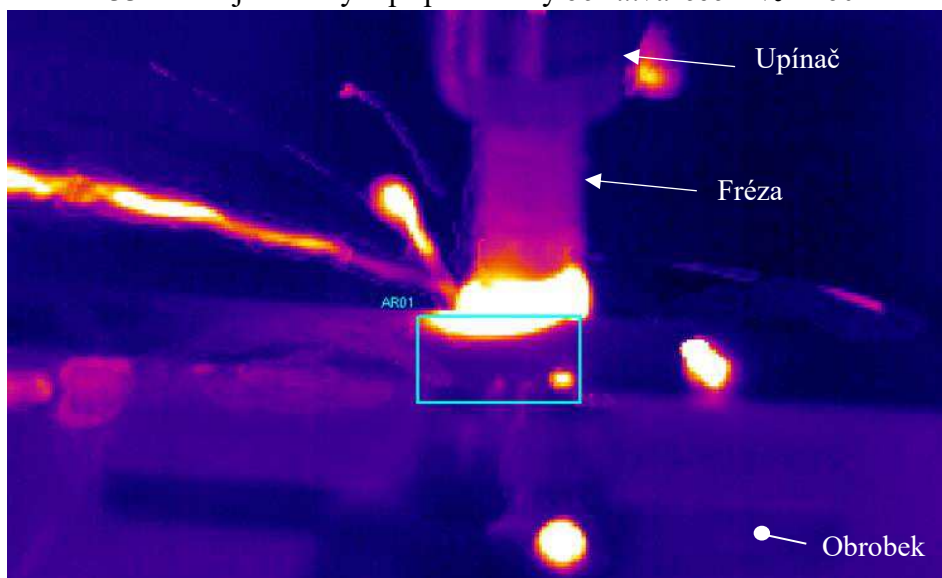
Obr. 4.134 Odlétající třísky v případě frézy EDMG a v_c=120 m/min.
