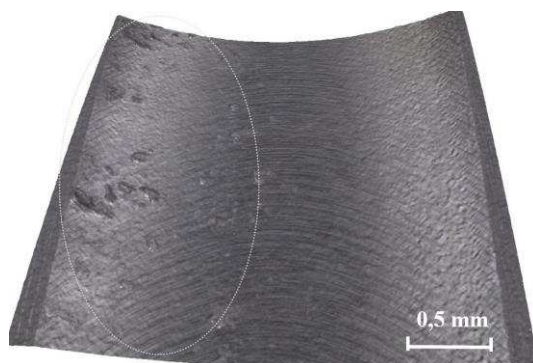
Obr. 4.81 Digitalizace obrobeného povrchu s vyznačenými nečistoty na straně nesouměrného frézování při naklonění nástroje vůči obrobku 20^\circ . Krok experimentu č. 6: n = 3979 \text{ min}^{-1} ; f_z = 0,03 \text{ mm} ; \beta_t = 20^\circ ; nástroj – HC.
