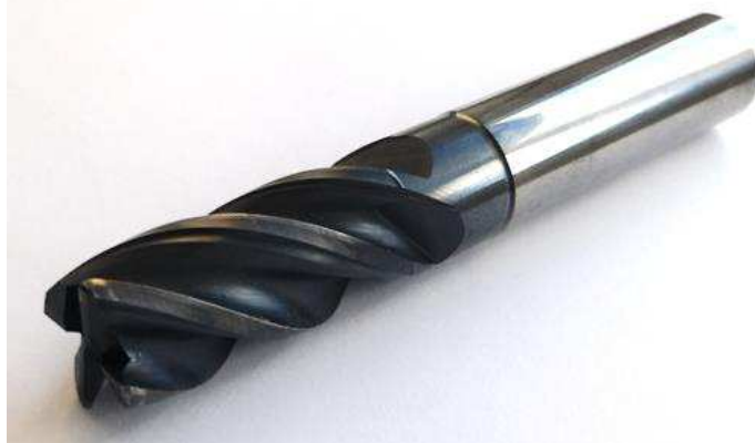
Obr. 4.123 Produkční nástroj použit pro srovnání velikosti daných sil vyvolaných nástroji prototypovými.
