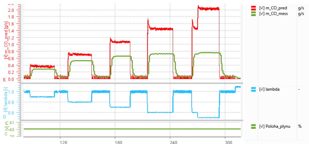
Obr. 28 Predikce surového oxidu uhelnatého pro 2145 \text{ min}^{-1} a 40 % zatížení
