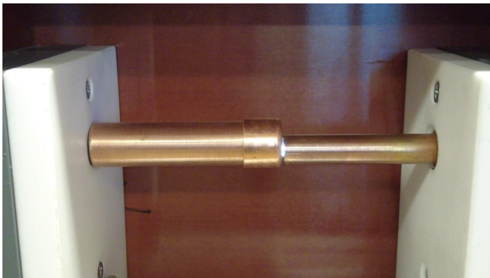
Obrázek 6.20: Oblouk v generátoru s dutou a plnou měděnou elektrodou
