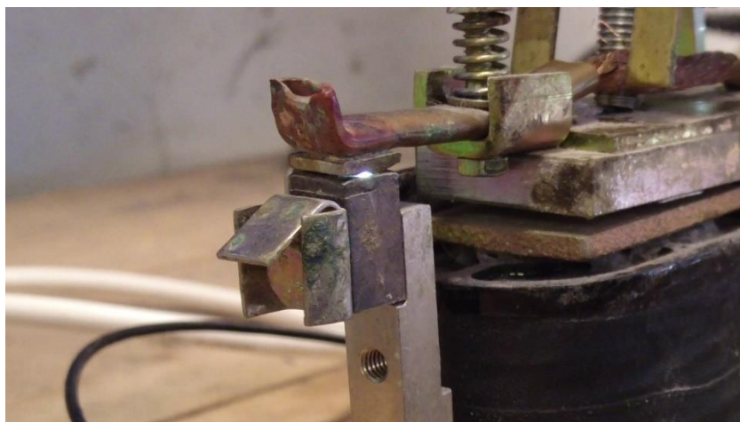
Obrázek 6.13: Oblouk mezi kontakty stykače
