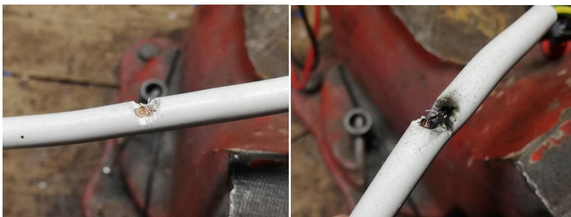
Obrázek 6.11: Přerušný kabel CYSY před a po testování, ochrana nevybavila
