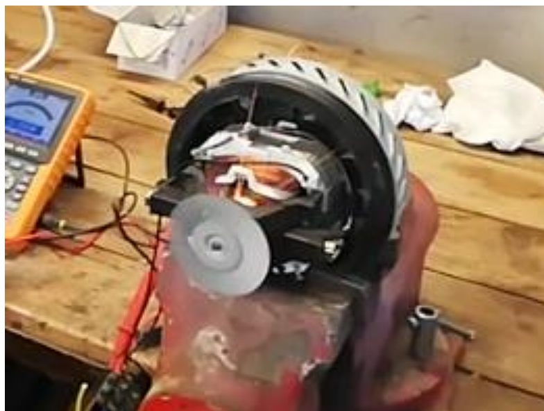
Obrázek 6.2: Jiskření komutátorového motoru se zkratem v rotoru
