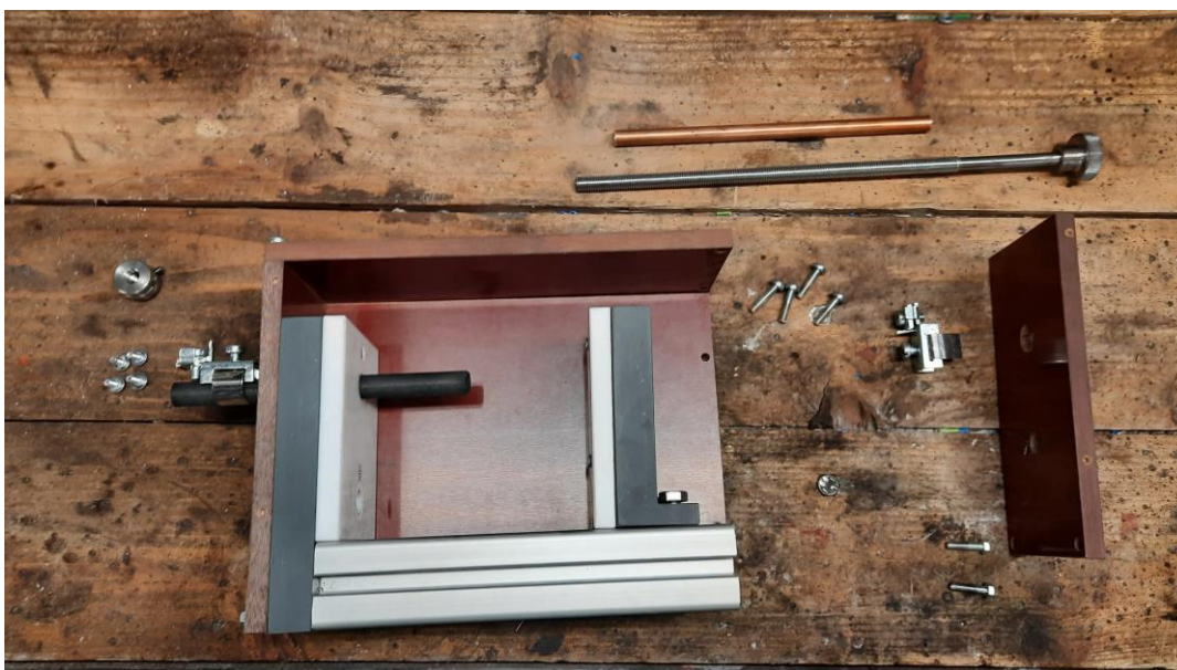
Obrázek 6.15: Rozložený generátor oblouku před mechanickými úpravami
