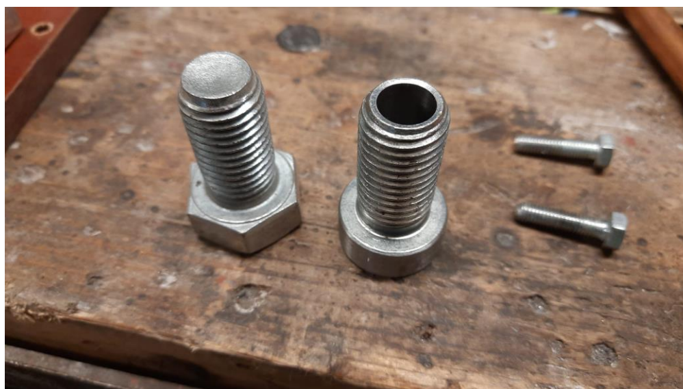
Obrázek 6.16: Vysoustružená redukce a původní šroub M16x30
