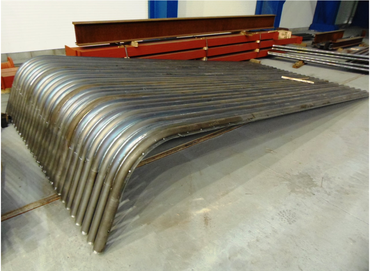
Obr. 4-2 Blok membránové stěny s ohybem [24]
