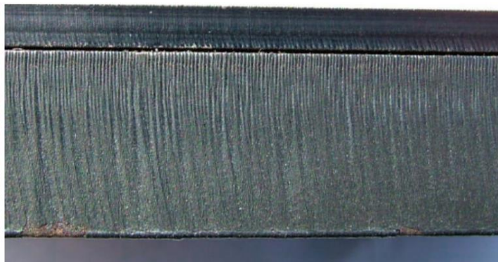
Obrázek 2.3 Detail řezu konstrukční oceli tloušťky 3 a 12 mm, obrobené oxidačním řezáním [52]
