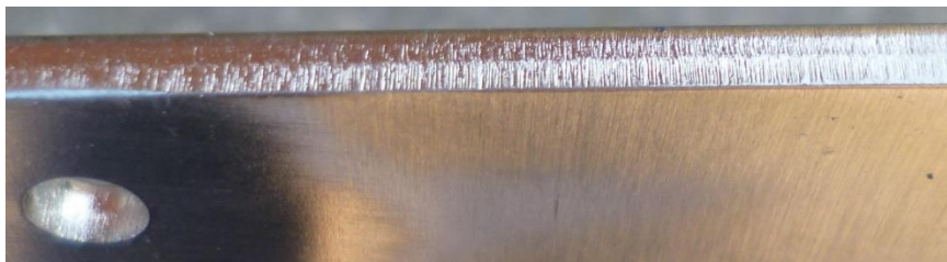
Obrázek 4.2 Detail řezu korozivzdornou ocelí tloušťky 3 mm vláknovým laserem
