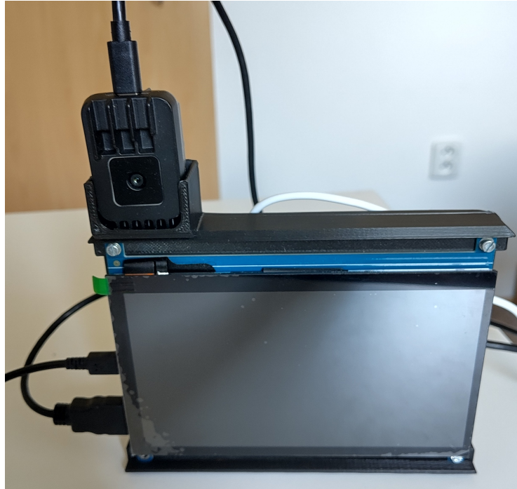
Obr. 2.6: Čelní pohled na první verzi systému, ukazuje OAK-1 a displej
