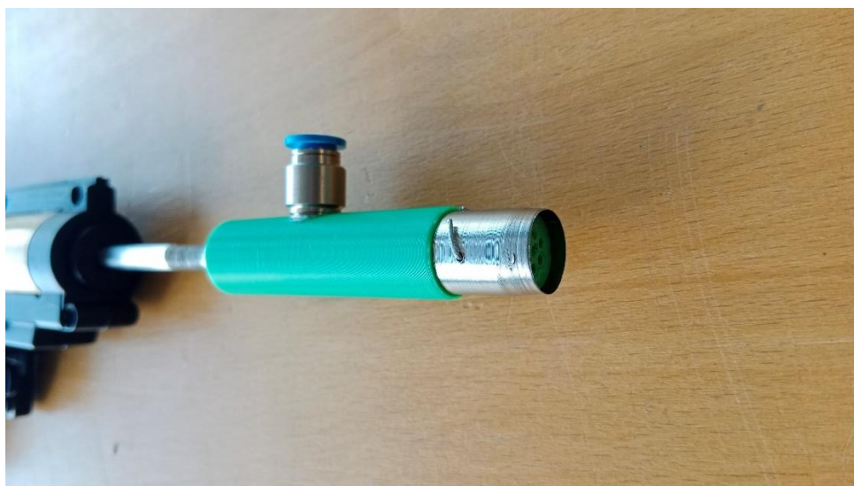
Obr. 24 Razný element uzpůsobený pro podtlak.
