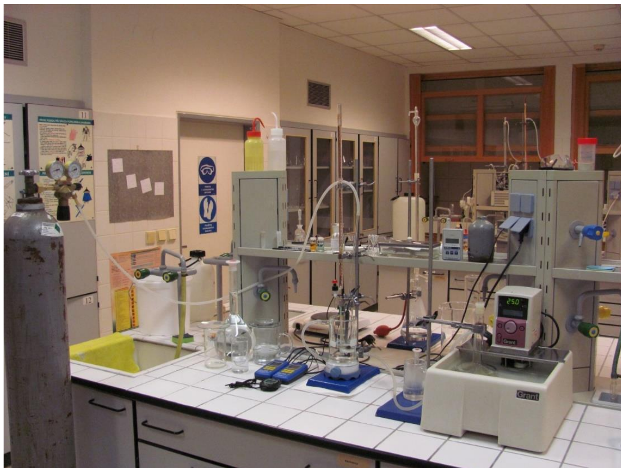
Obr.7: Aparatura použitá pro srážení hydroxidu hořečnatého a uhličitanu vápenatého z dolomitem neutralizovaného roztoku kyseliny chlorovodíkové.
