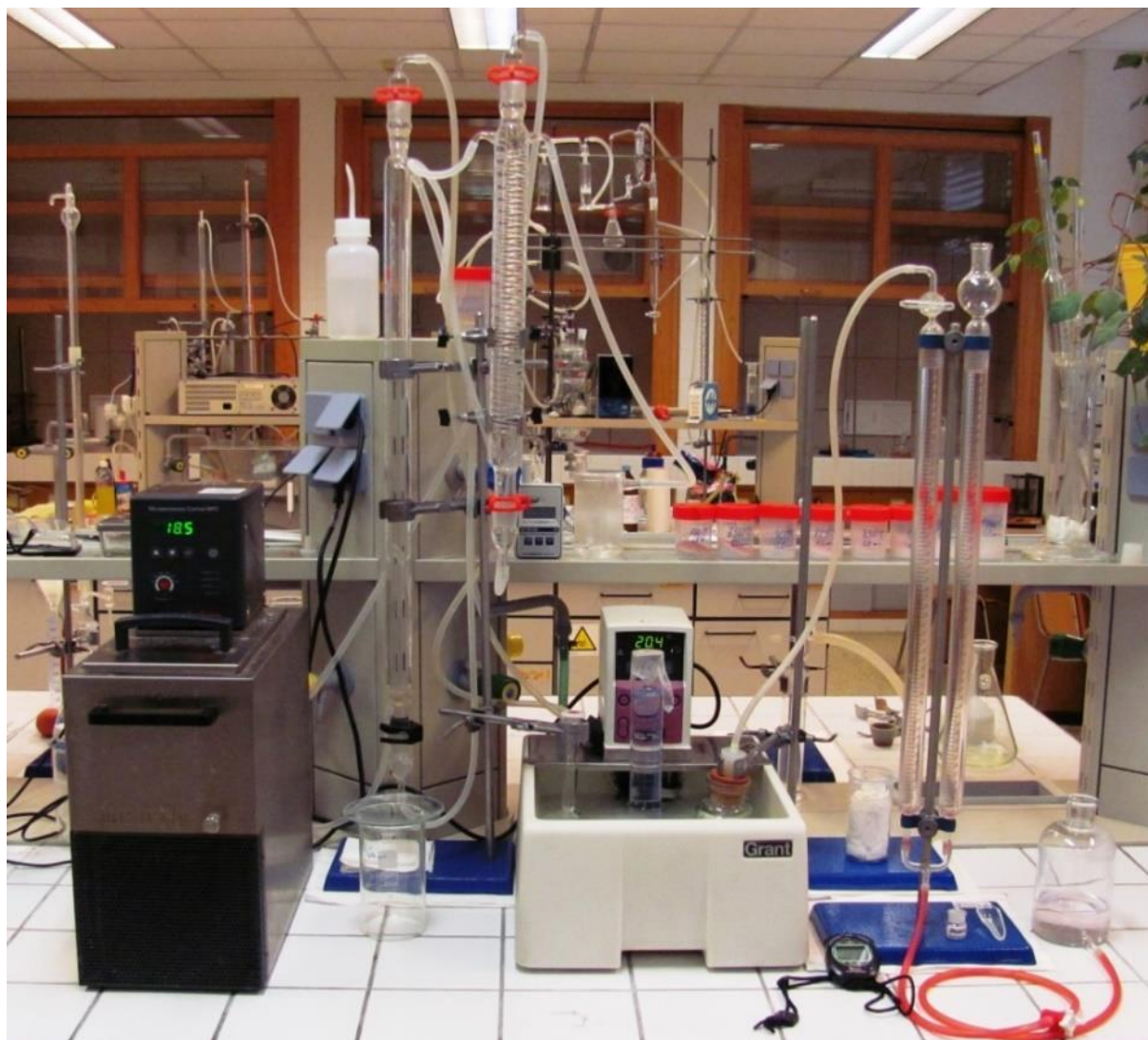
Obr.5: Aparatura použitá pro vyhodnocení mechanismu a kinetiky rozpouštění dolomitu v kyselině chlorovodíkové, která se sestává z termostatu a lázně a vápnoměru dle janka. Protože daný typ termostatu neumožňuje provádět měření za teplot nižších než laboratorní, byl přidán dalších chladicí okruh, který lze připojit na vodovodní řád nebo jiný termostat.
