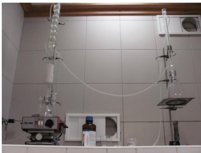
Obr.6: Příprava vzorku pro srážení Mg(OH)_2 a CaCO_3 prováděná s použitím Soxhletova extraktoru (vlevo) a vaření pod refluxem (vpravo).
