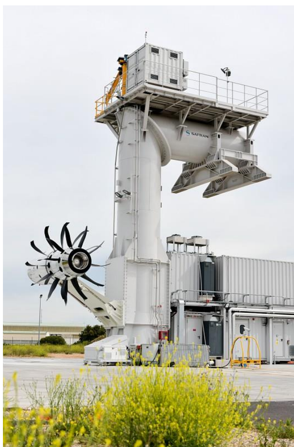
Obr. 13 – Fotografie pozemní zkoušky propfan motoru firmy Safran [60]
