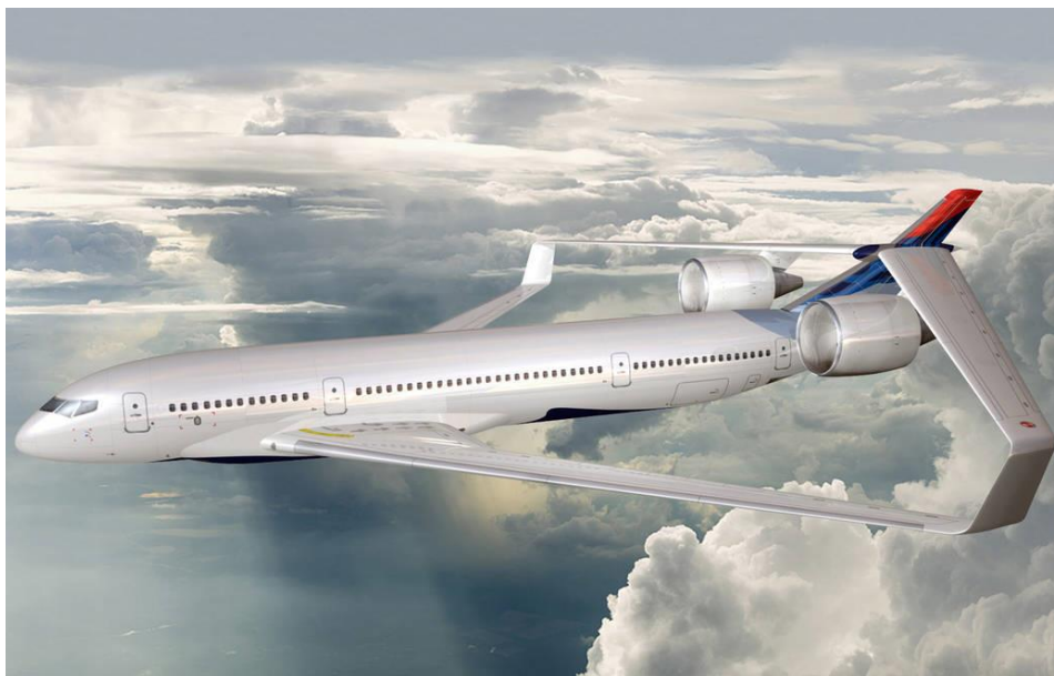
Obr. 10 – Příklad konstrukce box – wing letounu [82]
