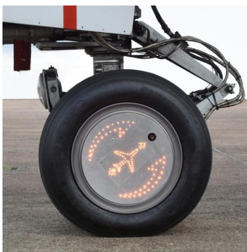
Obr. 7 – Přední kolo podvozku vybavené systémem WheelTug [43]
