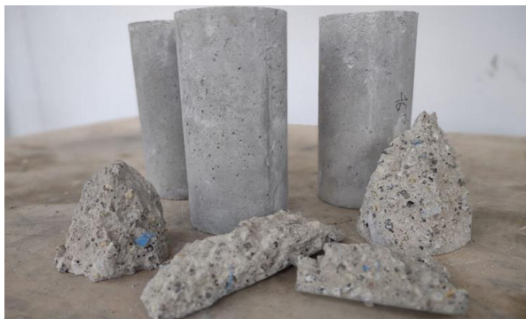
Obrázek č. 15: Beton s příměsí nadrcených ochranných pomůcek (Zdroj: Trendwatcher, 2023)
