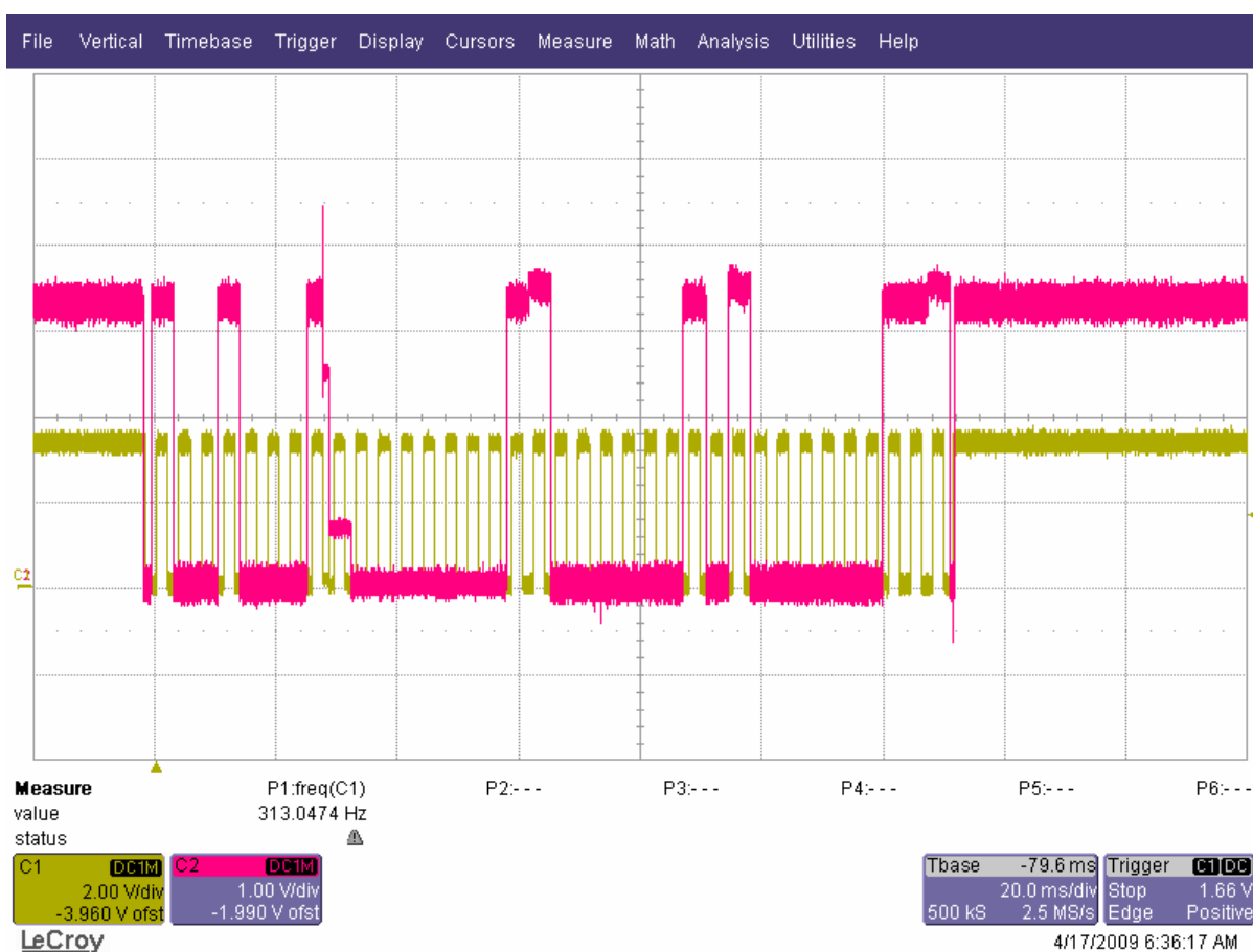
Obrázek 24: Výsledek komunikace I2C
