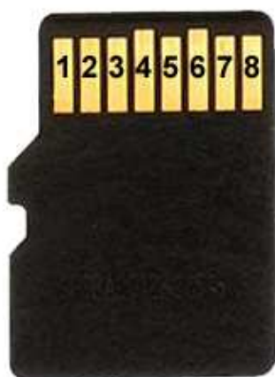
Obrázek 2.12 – Rozložení vývodů MicroSD karty a jejich připojení na SPI rozhraní[17]
