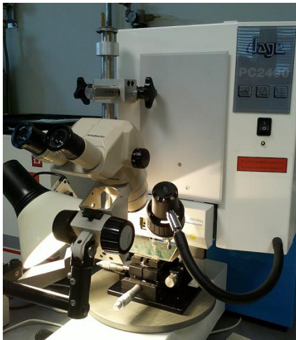
Obr. 4.6: Zařízení DAGE PC2400 (vlevo) a ukázka z testu stříhu (vpravo).
