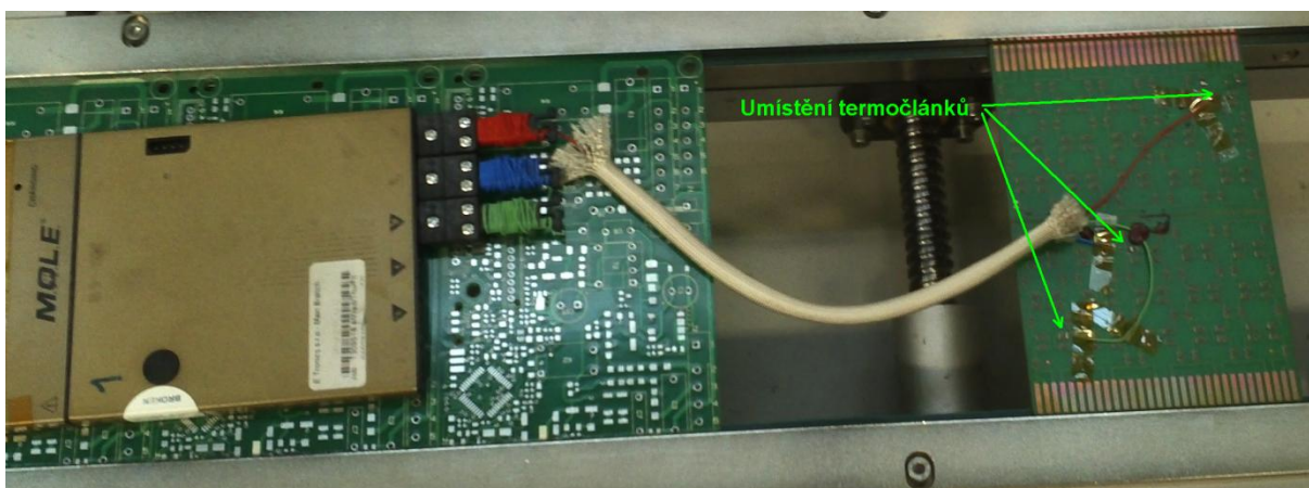
Obr. 4.4: Měření teplotních profilů - umístění termočlánků na profilovací DPS.
