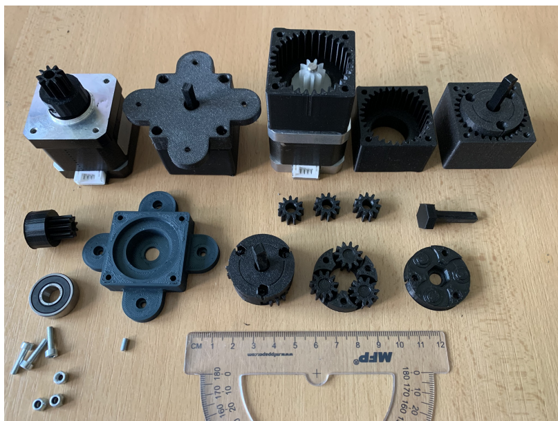
Obr. 4.1: 3D tlačená planetová prevodovka pre motor NEMA 17 a jej komponenty
