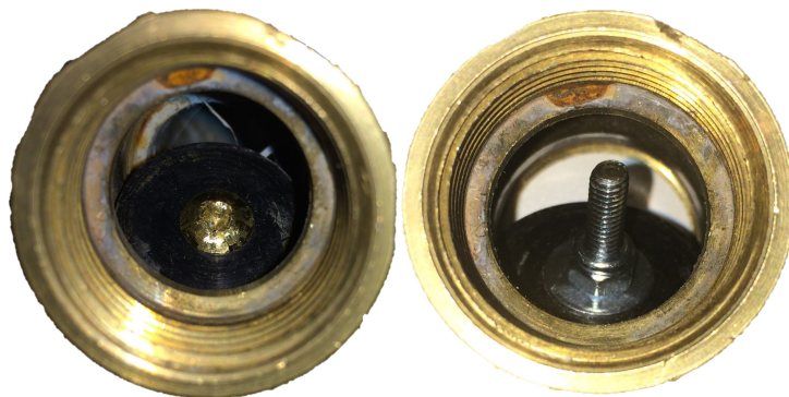
Obrázek 5.1: Tepací ventil bez úpravy (vlevo) a se závitovou tyčí na klapce (vpravo)
