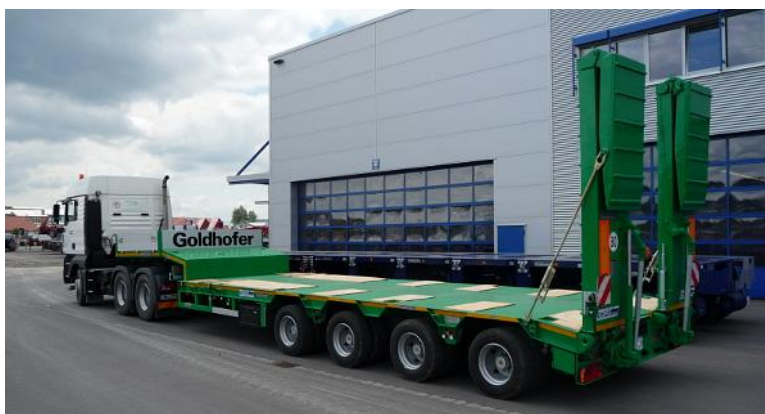
Obr. 32. Podvalník Goldhofer STN-L3 Bau:
