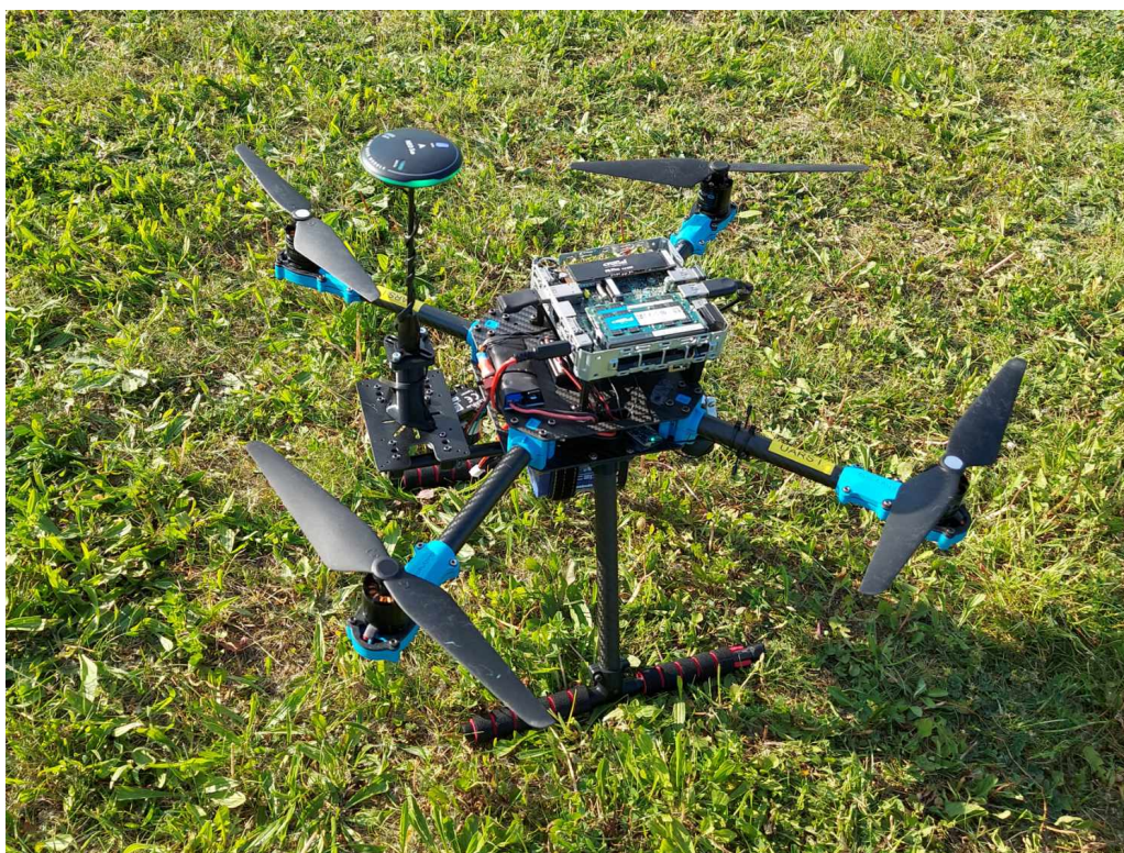
Obrázek 5.2: Dron Holybro X500 použitý pro testování
