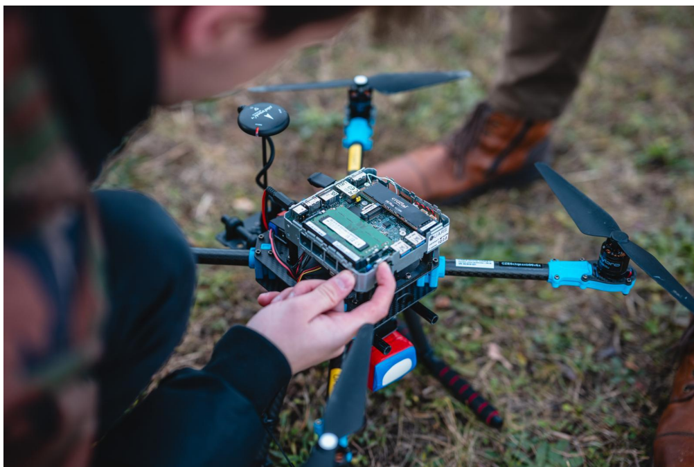
Obrázek 2.6: Dron s doprovodným počítačem typu Intel NUC, převzato z [29]
