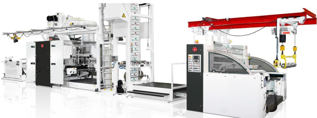
Obr. 18 Ukázka části výrobní linky s Flexotiskovým zařízením [36]
