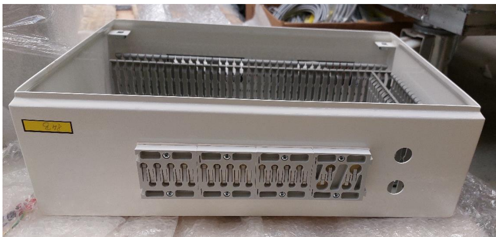
Obr. 27 Upravená svorkovnicová skříň
